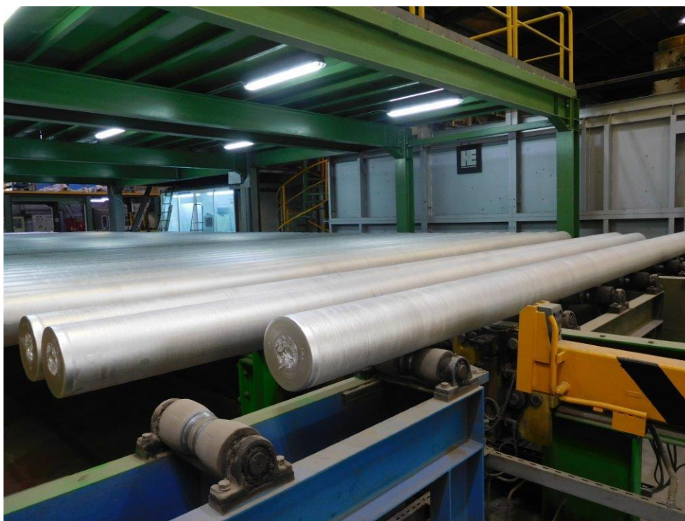
Εικόνα 1 Χυτές μπιγιέτες αλουμινίου πριν την εισαγωγή τους στο φούρνο ομογενοποίησης.
