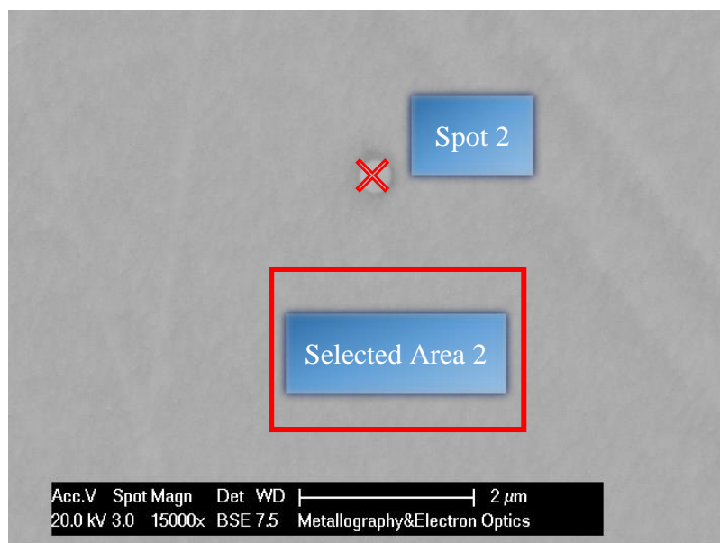
Σχήμα 31. Απεικόνιση των σχετικών περιοχών “Spot 2” και “Selected Area 2” λήψης φασμάτων με την τεχνική EDS από το δείγμα J.
