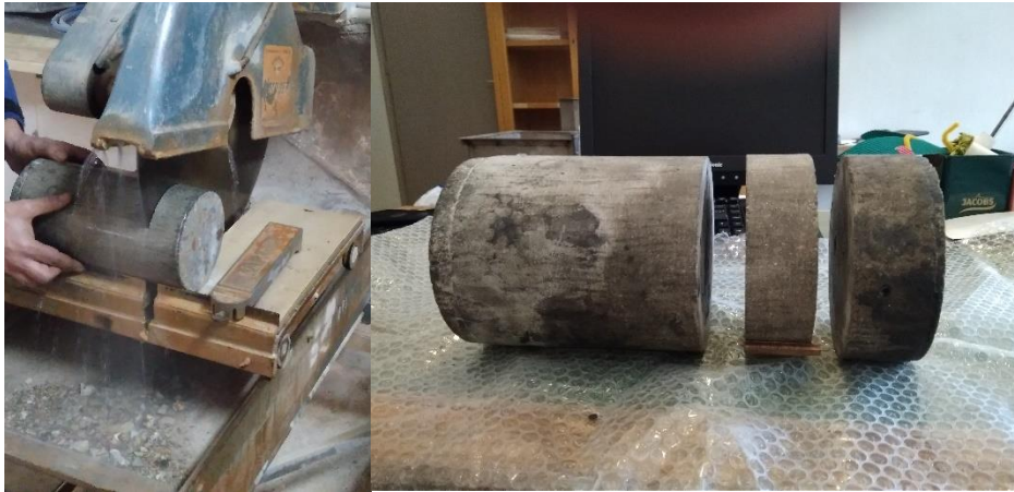
Εικόνα 27: Κοπή σκυροδέματος με αριθμό 3 με τη χρήση μηχανικού τροχού.
