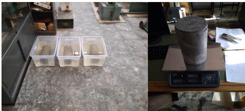
Εικόνα 30: Διαδικασία ζύγισης των δοκιμών πριν και μετά την εμβάπτισή τους σε νερό.
