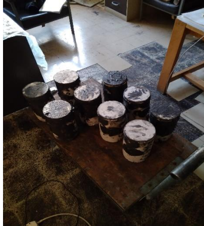
Εικόνα 20: Τα προς εξέταση δοκίμια με την μέθοδο των υπερήχων.
