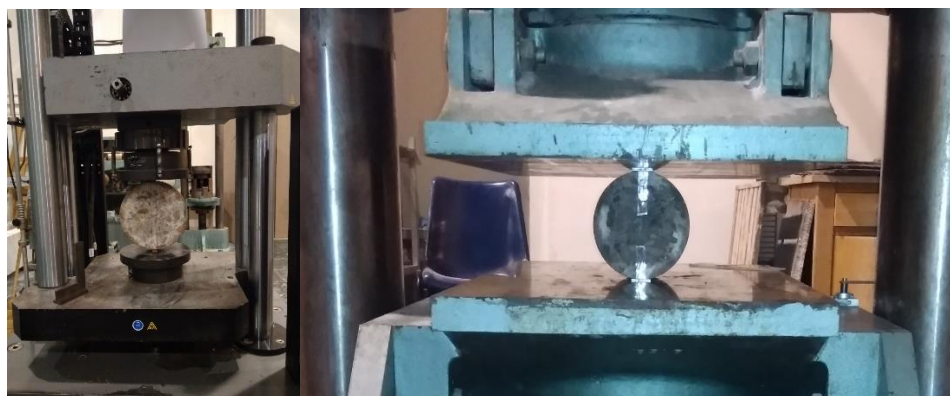
Εικόνα 29: Τοποθέτηση των δοκιμών στις μηχανές φόρτισης τύπου Instron 30 τόνων και τύπου Amsler 100 τόνων για την εκτέλεση της Αντιδιαμετρικής θλίψης.
