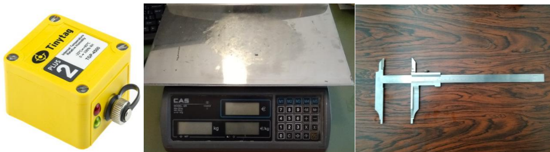
Εικόνα 21: Επιστημονικά όργανα προσδιορισμού των φυσικών παραμέτρων των δοκιμών σκυροδέματος.
