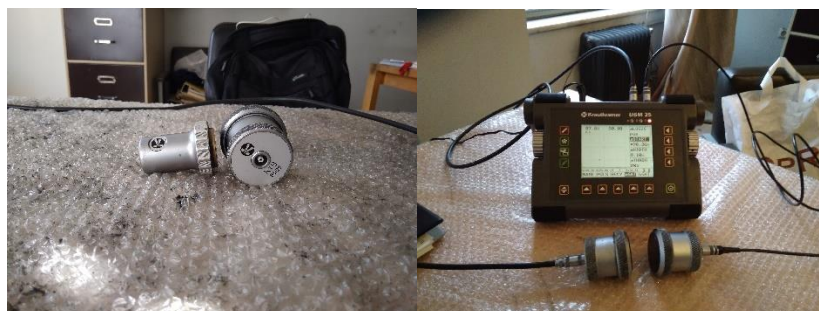
Εικόνα 23: Πιεζοηλεκτρικοί μετατροπείς K1SM και K1S συνδεδεμένοι με την υπερηχητική συσκευή USM 25.
