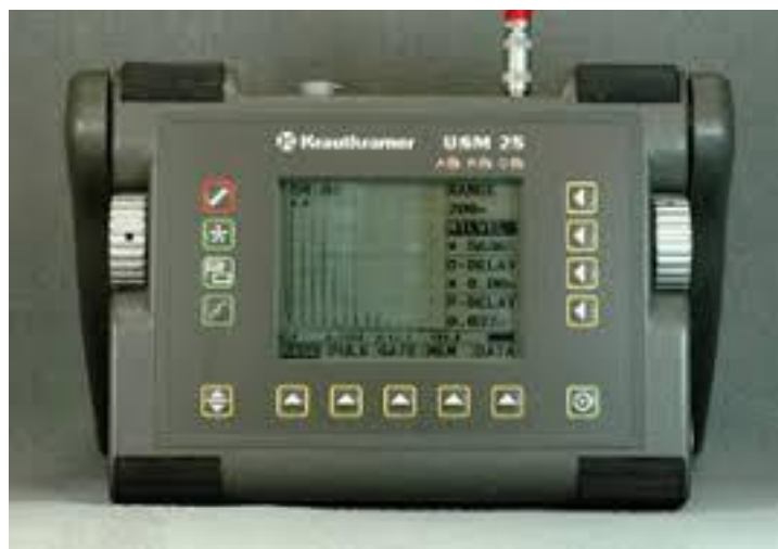
Εικόνα 22: Συσκευή υπερήχων USM 25 της εταιρείας Krautkramer.
