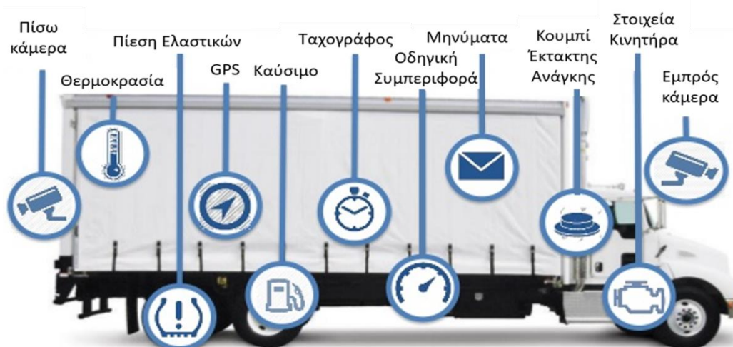
Σχήμα 1.- Αισθητήρες και συσκευές φορτηγών οχημάτων
