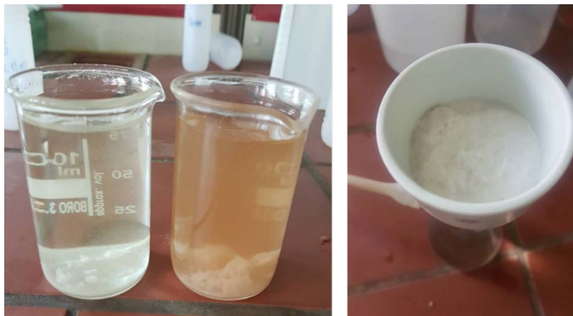
Εικόνα 44. Καταβύθιση ιζήματος σε 90°C, 2N, 5%φω/ρ, 15 min, <200μm μέγεθος κόκκων
