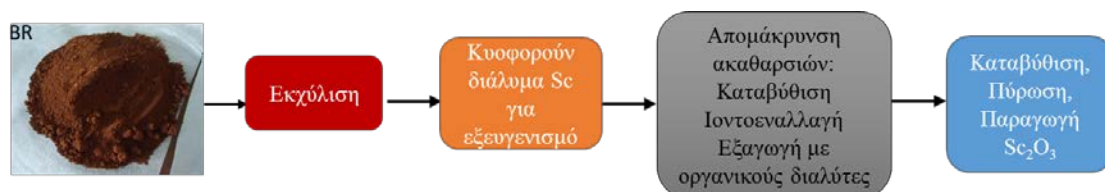
Εικόνα 13. Διεργασία που ακολουθείται κατά την άμεση εκχύλιση με υδρομεταλλουργικά μέσα
