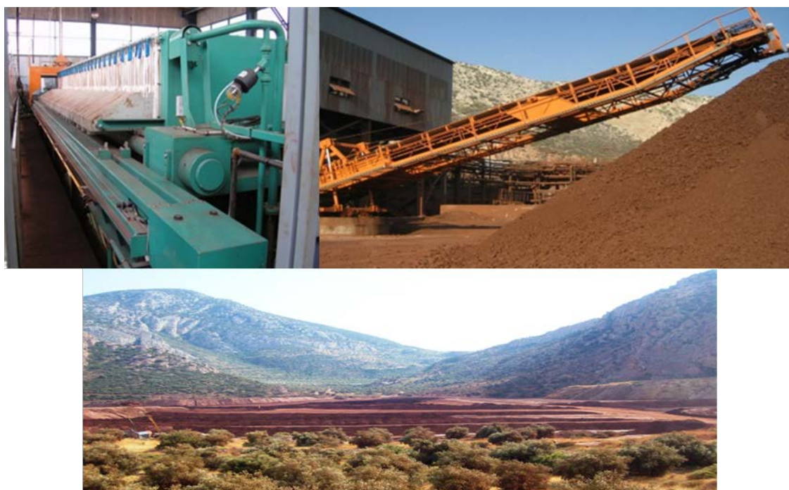
Εικόνα 6. Πάνω αριστερά φιλτρόπρεσσες, πάνω δεξιά ξηρά κατάλοιπα βωξίτη, κάτω χώροι απόθεσης στο Αλουμίνιο της Ελλάδας
