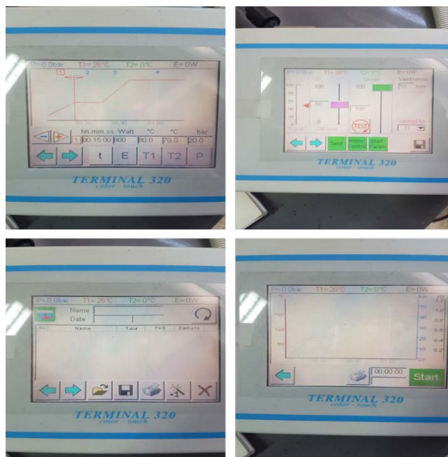
Εικόνα 25. Ρύθμιση συνθηκών εκχύλισης μέσω της κονσόλας του microwave
