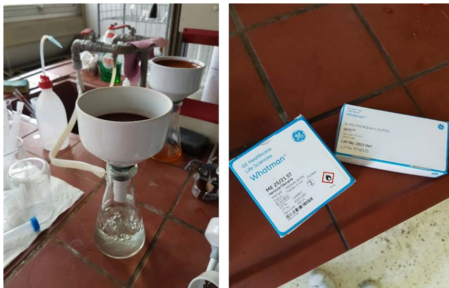
Εικόνα 27. Αριστερά διήθηση πολφού μετά το πέρας των 60 λεπτών- Δεξιά χρήση κατάλληλων φίλτρων για τη διήθηση
