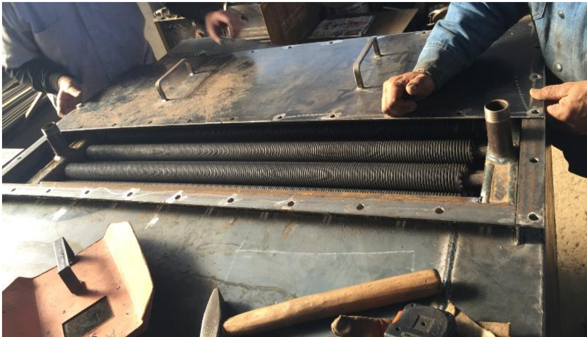
Εικόνα 5.3: Η στιγμή της εισαγωγής και συναρμολόγησης του εσωτερικού στοιχείου στο εξωτερικό κέλυφος-περίβλημα [29]
