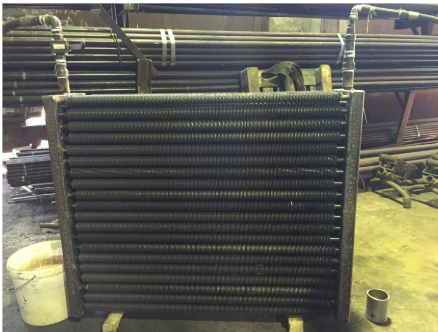
Εικόνα 5.1: Εσωτερικό αυλωτό πτερυγιοφόρο στοιχείο συναλλαγής θερμότητας [29]
