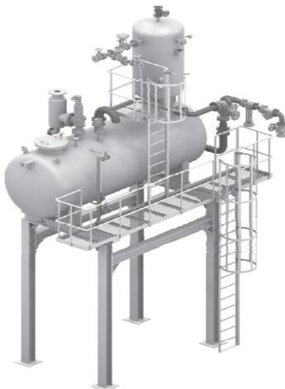
Εικόνα 2.1: Δεξαμενή τροφοδοσίας νερού λέβητα με απαεριστή [9]
