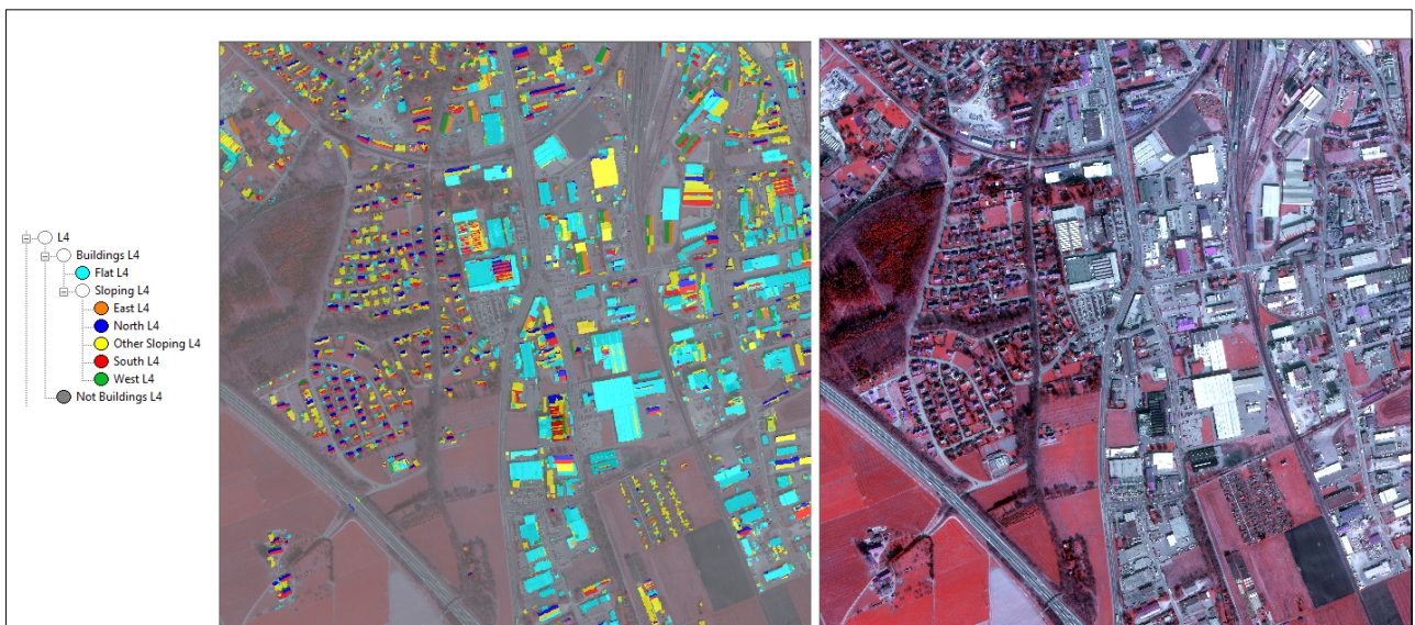
Εικόνα 206: Τελική Ταξινόμηση στο Επίπεδο L4 (αριστερά), έγχρωμο σύνθετο 432 (δεξιά). Είναι εμφανής η ύπαρξη πολλών αδιευκρίνιστων προσανατολισμών κυρίως στα μικρά κτήρια. Project του eCognition για την αναγνώριση του τύπου και των τμημάτων οροφών.
