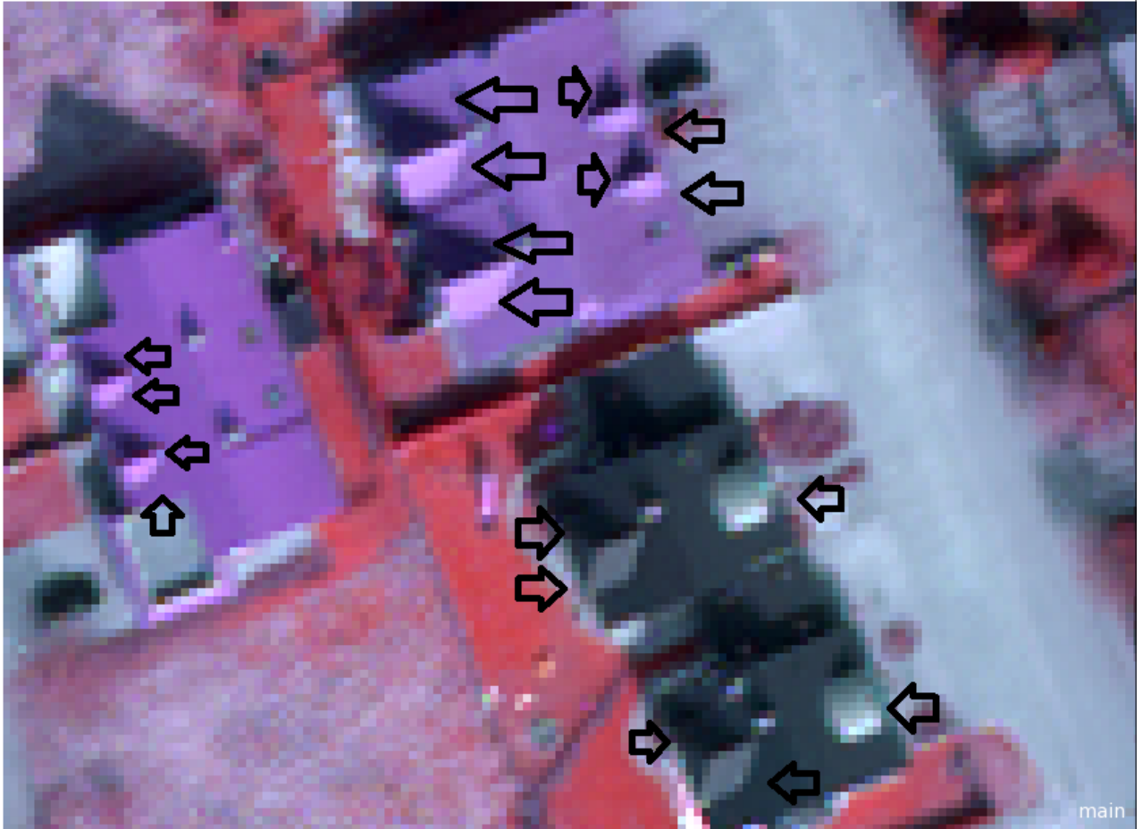
Εικόνα 215: Παραδείγματα μικρών τμημάτων επικλινών οροφών. Project του eCognition για την αναγνώριση του τύπου και των τμημάτων οροφών.
