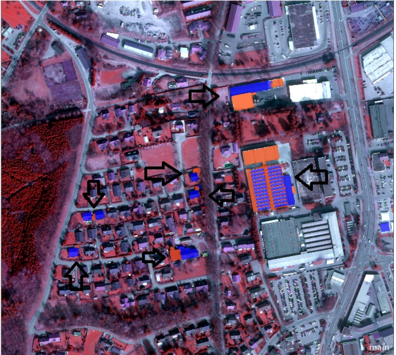
Εικόνα 239: Παραδείγματα κάποιων κτηρίων (μαύρα βέλη) που χρησιμοποιήθηκαν για να ληφθούν δείγματα των Flat LFA(πορτοκαλί χρώμα) και Sloping LFA(μπλε χρώμα). Project του eCognition για την αναγνώριση του τύπου και των τμημάτων οροφών.
