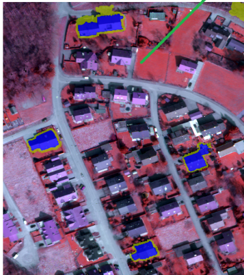
Εικόνα 154: Δείγματα για Buildings LFA, στο Level For Accuracy (έγχρωμο σύνθετο 432 και με μπλε τα δείγματα) . Project του eCoanition για τον εντοπισμό οροφών κτηρίων.
