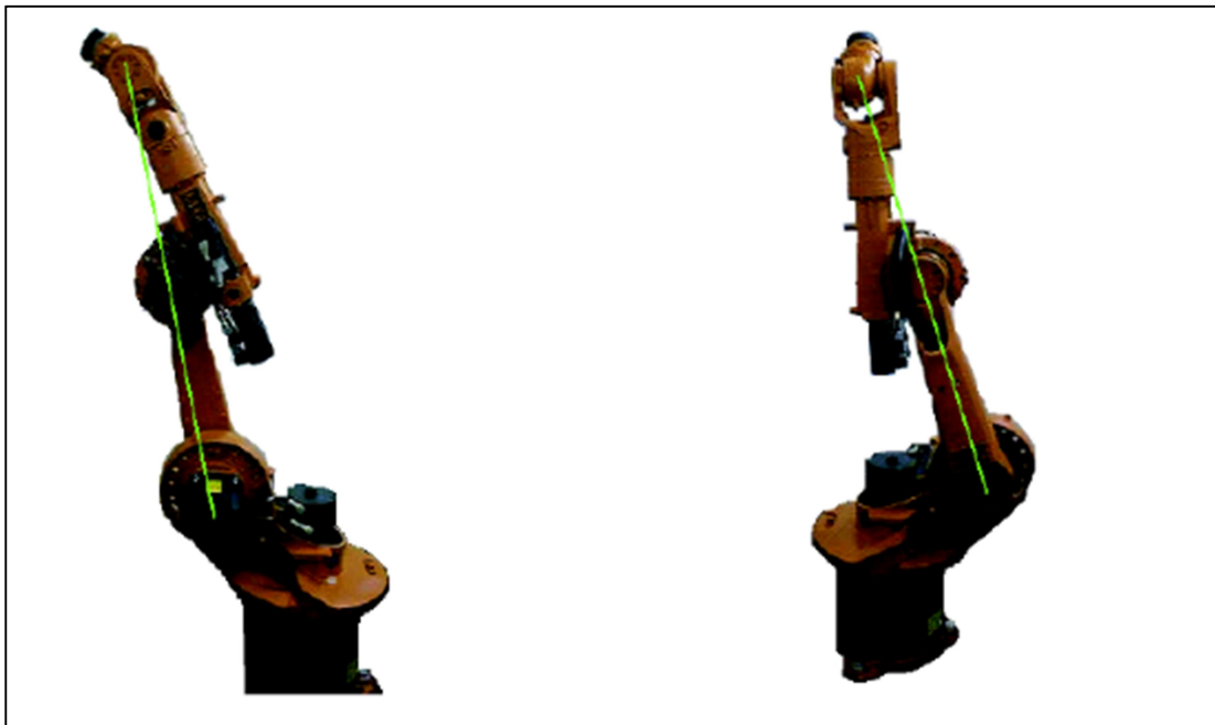
Σχήμα 4.2.1. Ιδιομορφία αγκώνα στον ρομποτικό βραχίονα της KUKA KR 15/1
