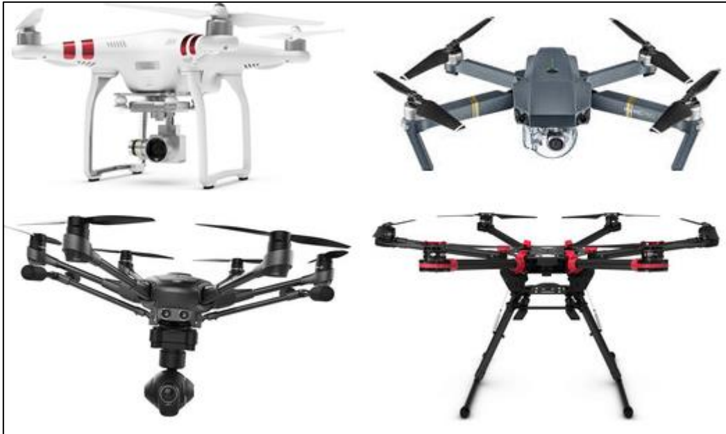
Εικόνα 1.6: UAV Πλατφόρμες πολλαπλών στροφείων ( δεξιά πάνω: DJI Phantom 3 Standard, αριστερά πάνω: DJI Mavic Pro, δεξιά κάτω: Yuneec Typhoon H Pro, αριστερά κάτω: DJI Spreading Wings S900)
