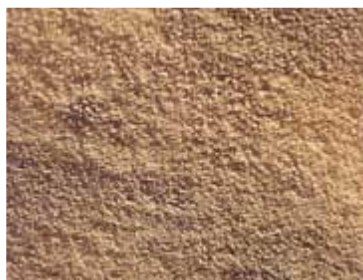
Σχήμα 1- 5. Φωτογραφία που απεικονίζει φθορά των μαρμάρων της Ακρόπολης από την όξινη βροχή
