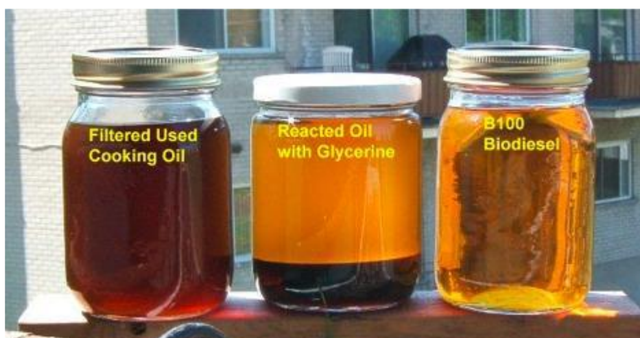
Σχήμα 4 - 16. Μορφή ελαίου κατά την ανάμιξη με γλυκερίνη για τη δημιουργία βιοντίζελ
