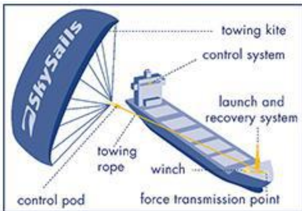
Σχήμα 5 - 7. Χαρακτηριστικό παράδειγμα χαρταετού ρυμούλκησης
