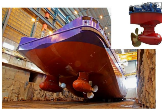
Σχήμα 3 - 14. Προωστήρας azimuth του παγοθραυστικού "Vitus Bering"
