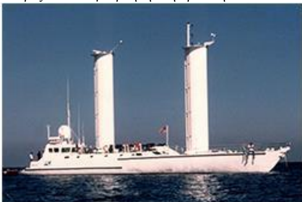
Σχήμα 5 - 6. Πλοία που χρησιμοποιούν ρότορες Flettner. Alcyone του Cousteau και δεξιά το E-Ship 1.
