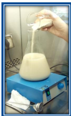
ΕΙΚΟΝΑ Ε.4.1 Παρασκευή αιωρήματος μαγιάς 10 % W/W .
