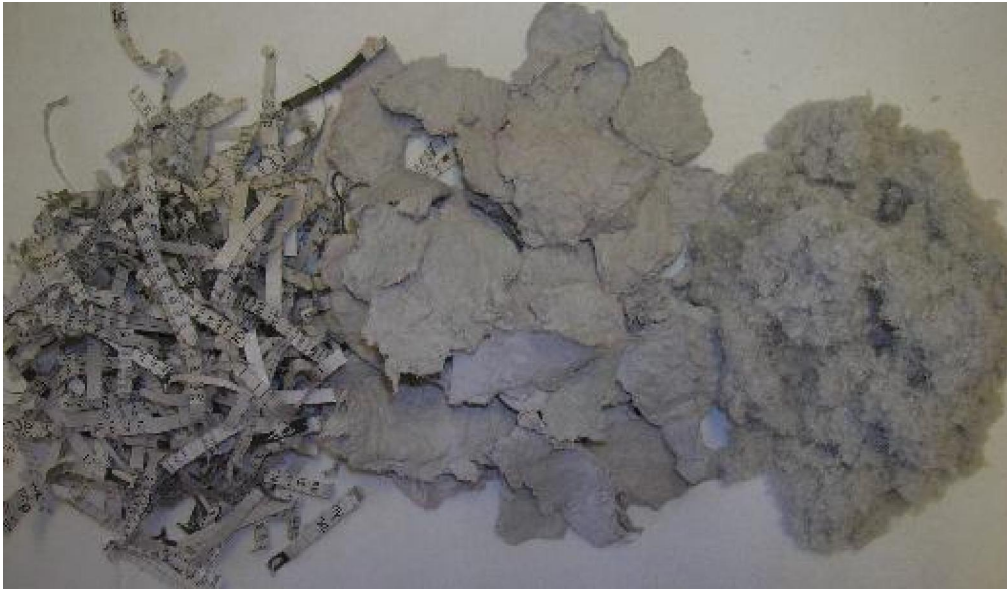
Σχήμα 4.18: Στάδια προετοιμασίας προσροφητικού μέσου: τεμαχισμός εφημερίδας, ζήρανση μετά την πολτοποίηση και τελική μορφή προσροφητικού
