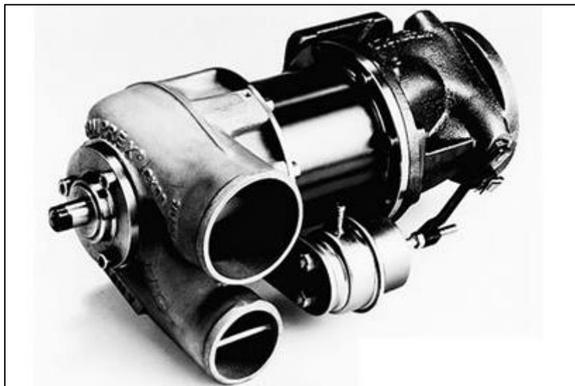
Σχήμα 1.8β: Σύστημα υπερπλήρωσης Comprex σε εφαρμογή σε Mazda 626 Capella 2,0L Diesel
