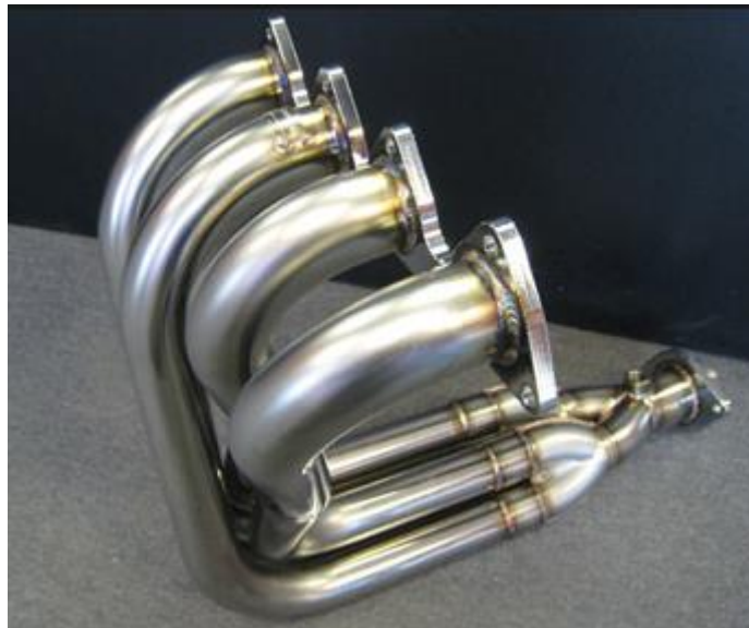
Σχήμα 2.6: Πολλαπλή εξαγωγής κινητήρα (4→2→1)
