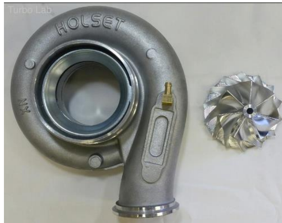
Σχήμα 2.3: Πτερωτή και κέλυφος συμπιεστή της εταιρείας Holset (HX40)
