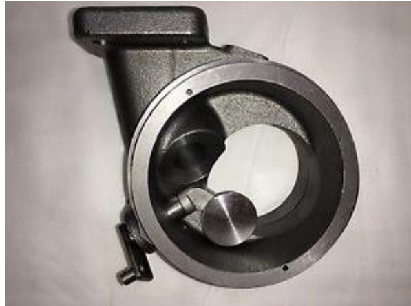
Σχήμα 2.7: Κέλυφος στροβίλου και βαλβίδα παράκαμψης καυσαερίου (wastegate) της εταιρείας Garrett
