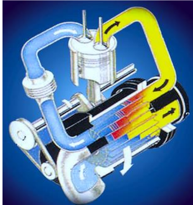
Σχήμα 1.8α: Σύστημα υπερπλήρωσης Comprex
