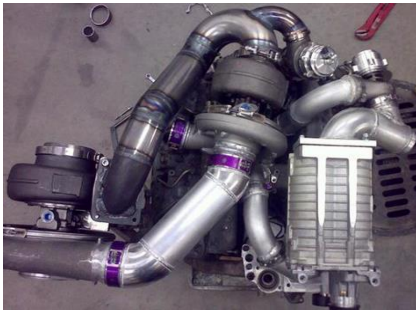
Σχήμα 1.18: Φωτογραφία συστήματος compined supercharging, 2-βάθμιο με μηχανικό συμπιεστή Roots, Duramax LB7.
