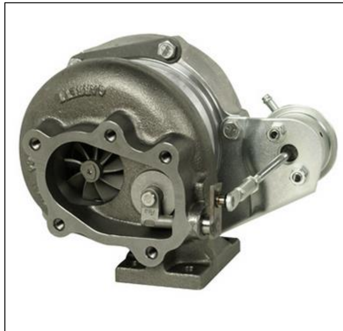
Σχήμα 2.10: Εσωτερική βαλβίδα παράκαμψης καυσαερίου (internal wastegate)
