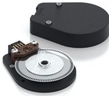
Σχήμα 85: Αισθητήρας ταχύτητας περιστροφής E6 της εταιρίας US Digital.
