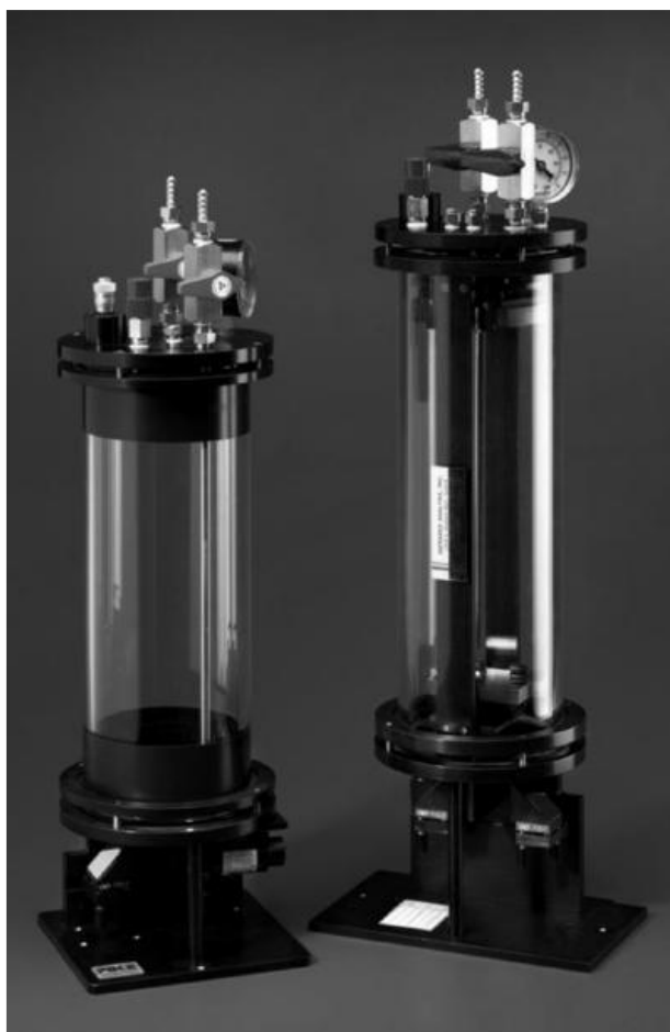
Εικόνα 36: Ζεύγος μικρών διαστάσεων, πολλαπλών διελεύσεων και μεγάλου μήκους διαδρομής λευκών κυψελών με γυάλινα σώματα.
