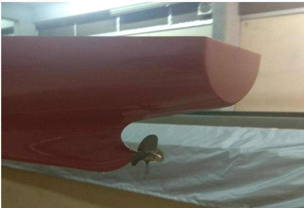
Εικόνα 7.1 Τοποθέτηση έλικας στο μοντέλο
