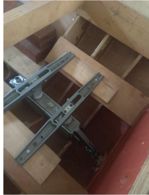
Εικόνα 3.8 Τοποθέτηση Κινητήρα και Δυναμόμετρου Ωσης και Ροπής
