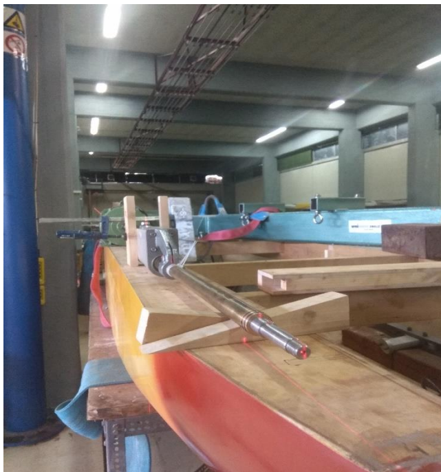
Εικόνα 3.10 Απομόνωση του συστήματος – Ευθυγράμμιση με λέιζερ - Μετρήσεις γωνίας και ταλαντώσεων
