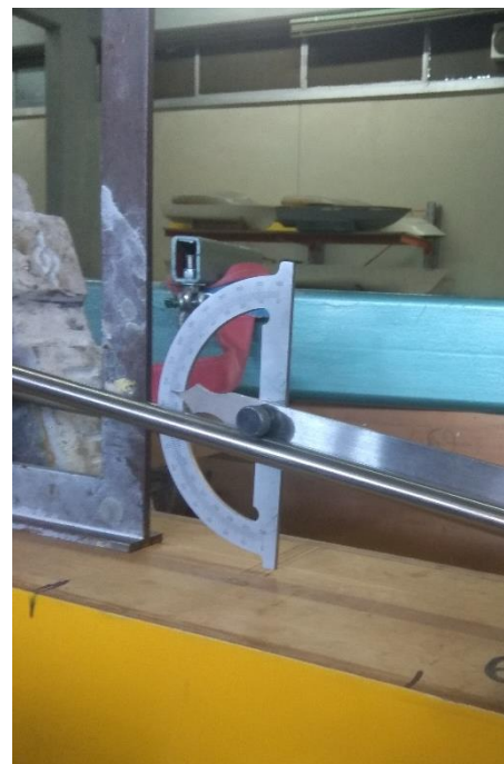
Εικόνα 3.10 Απομόνωση του συστήματος – Ευθυγράμμιση με λέιζερ - Μετρήσεις γωνίας και ταλαντώσεων
