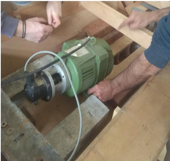
Εικόνα 3.8 Τοποθέτηση Κινητήρα και Δυναμόμετρου Ωσης και Ροπής
