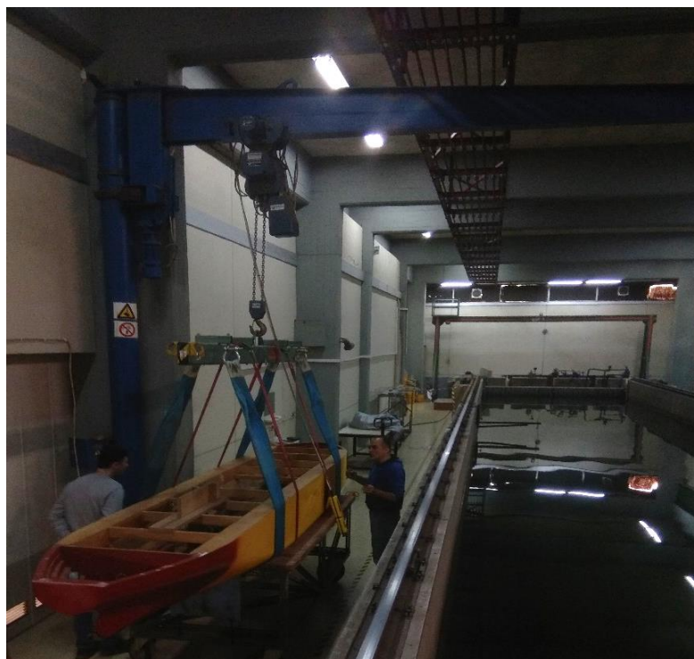
Εικόνα 3.14 Έναρξη Διαδικασίας Καθέλκυσης Πλήρους Εξοπλισμένου Μοντέλου
