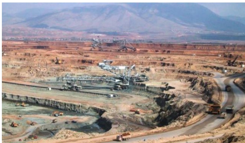
Εικ.15 Εξόρυξη με την μέθοδο των ορθών βαθμίδων στο λιγνιτωρυχείο Αχλάδας στην περιοχή Φλώρινας
