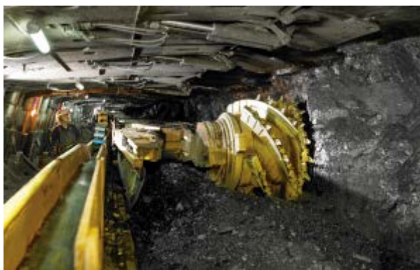
Εικ.18 Μηχανήματα εξόρυξης τοιχωμάτων σε ανθρακωρυχείο του Κολοράντο»[129]
