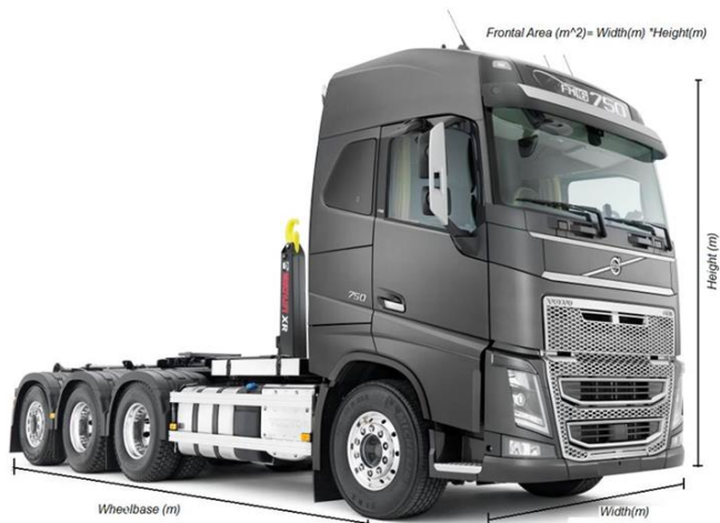
Σχήμα 5.1 : Απεικόνιση βασικών διαστάσεων ενός οχήματος βαρέος τύπου
