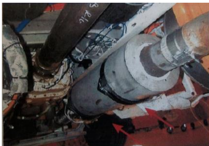
Σχήμα 1.9: Εφαρμογή της εταιρείας Hi-Z σε βαρύ όχημα με εγκατάσταση θερμοηλεκτρικής γεννήτριας για την ανάκτηση της θερμότητας του καυσαερίου [2]
