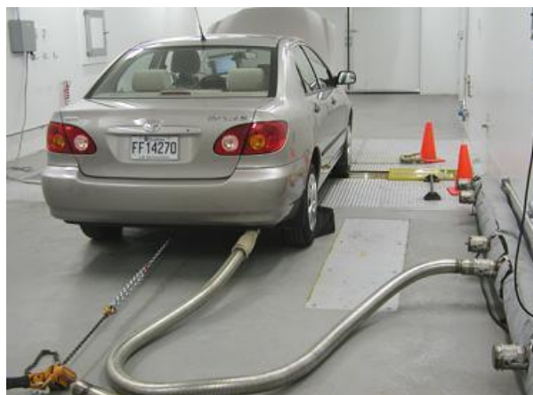
Σχήμα 4.1: Επιβατικό αυτοκίνητο στο δυναμόμετρο πλαισίων [24]
