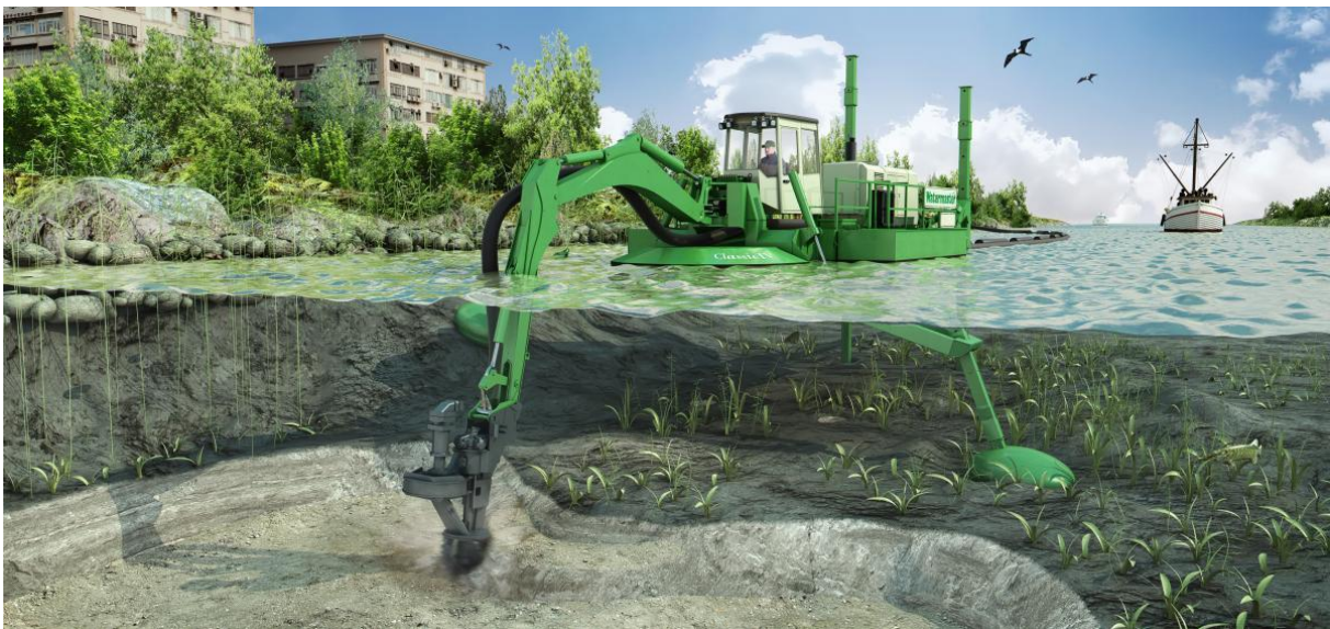
Εικόνα 5.16 Υδραυλική βυθοκόρος με κεφαλή κοπής και αναρρόφηση Watermaster
