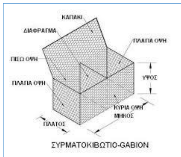
Εικόνα 5.18 Γεωμετρία Κιβωτίου gabion
