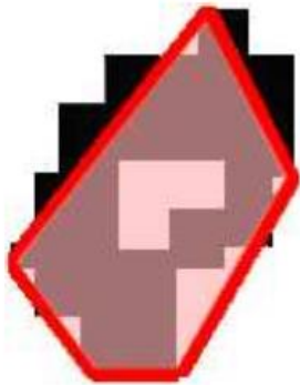
Εικόνα 19: Το Area (including inner polygons) όπως υπολογίζεται από το eCognition για ένα πολύγωνο μέσα στο οποίο υπάρχει άλλο πολύγωνο (Πηγή: eCognition Developer 8.7 User's Guide, 2011)
