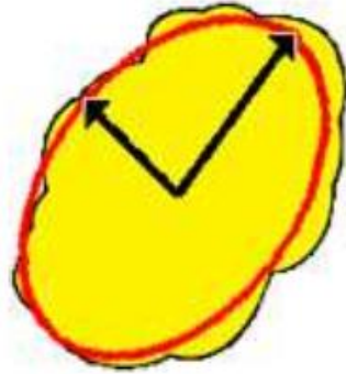
Εικόνα 12: Το Elliptic fit ενός αντικειμένου όπως υπολογίζεται από το eCognition (Πηγή: eCognition Developer 8.7 User's Guide, 2011)
