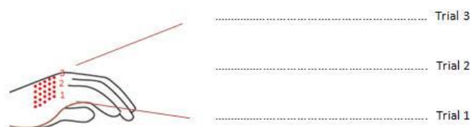
Εικόνα 44: Κάθε σειρά αποτελείται από 10 παλμούς CO 2 laser διάρκειας 10ms ο καθένας.
