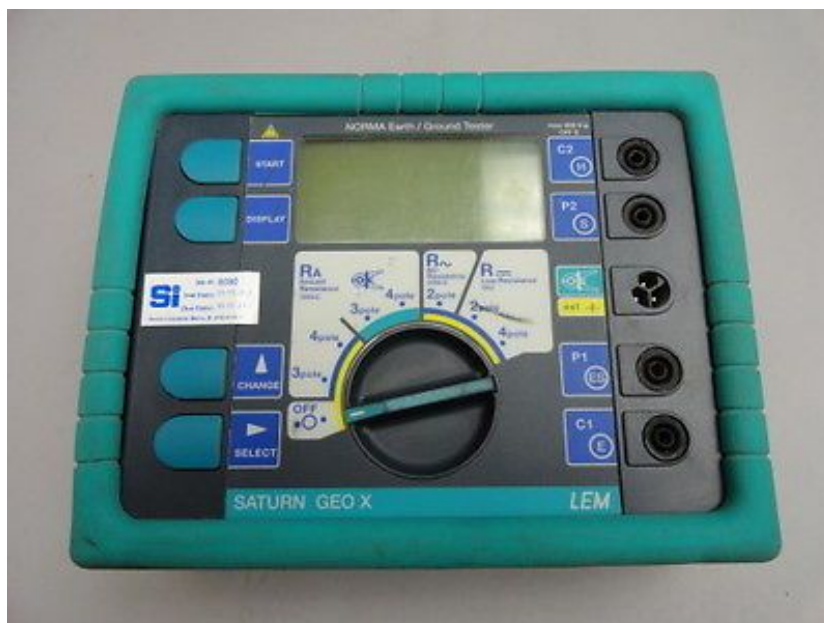
Εικόνα 4.10: Το όργανο μέτρησης LEM SATURN GEO-X Earth Tester.
