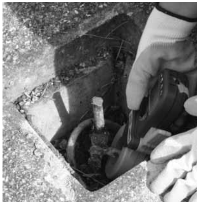
Εικόνα 2.1: Εφαρμογή της clamp-on μεθόδου στην πράξη [11].
