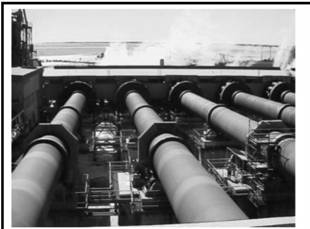
Εικόνα 4.21 : Περιστροφική Κάμινος Ξηρής Κατεργασίας Μεγάλου Μήκους - «Rotary Kilns», A.A. Boateng / FLS Minerals-Denmark
