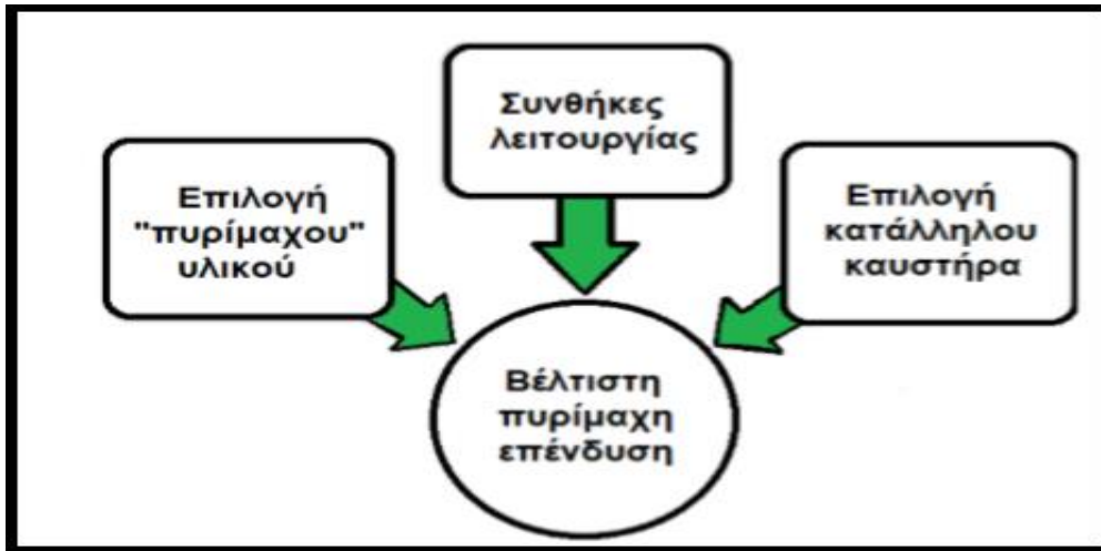
Εικόνα 4.19 : Κριτήρια Επιλογής Κατάλληλης Πυρίμαχης Επένδυσης - «Πυρίμαχη Επένδυση Περιτροφικών Καμίνων Κλίνκερ Τσιμέντου», Κ.Γ. Τσακαλάκης
