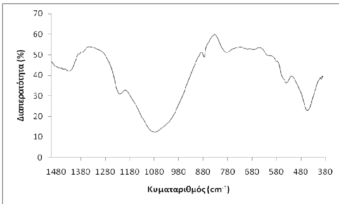
Διάγραμμα 2.8: FT-IR Ανάλυση Καφέ Δείγματος Με Αλουμινικό Νάτριο Με Χρήση Φούρνου Μικροκυμάτων
