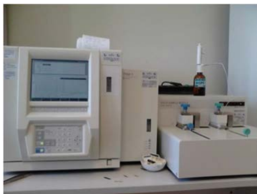
Σχήμα 27: Συσκευή μέτρησης TOC
