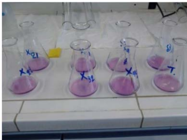
Σχήμα 34: Προετοιμασία δείγματος βορικού και δείκτη
