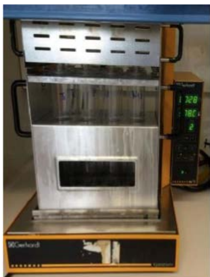
Σχήμα 32: Συσσκευή χώνευσης Gerhardt
