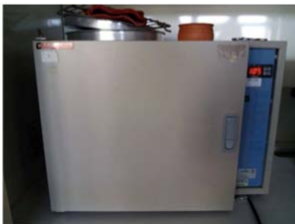
Σχήμα 24: Φούρνος ξήρανσης με ρεύμα αέρα
