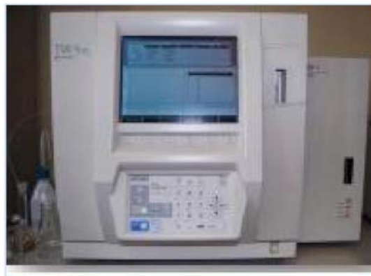
Σχήμα 29: Φούρνος (Solid Sample Module SSM 5000A)
