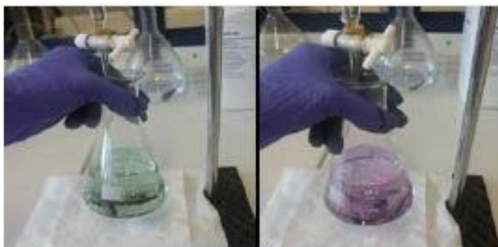
Σχήμα 35: Μετά την απόσταξη και πριν την τιτλοδότηση (αριστερά) και μετά την τιτλοδότηση (δεξιά)
