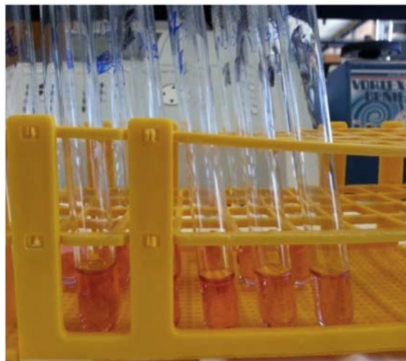
Σχήμα 40: Προσδιορισμός ελεύθερης γλυκόζης με τη μέθοδο GOD/PAP
