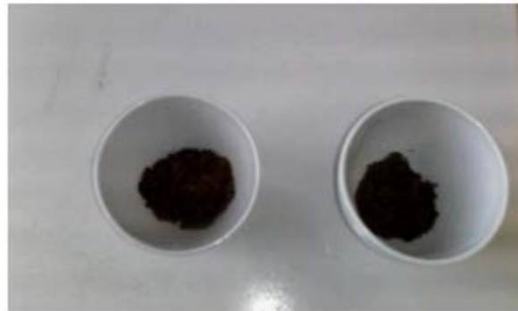
Σχήμα 25: Ζύγιση ξηρού υλικού σε κάψες πορσελάνης
