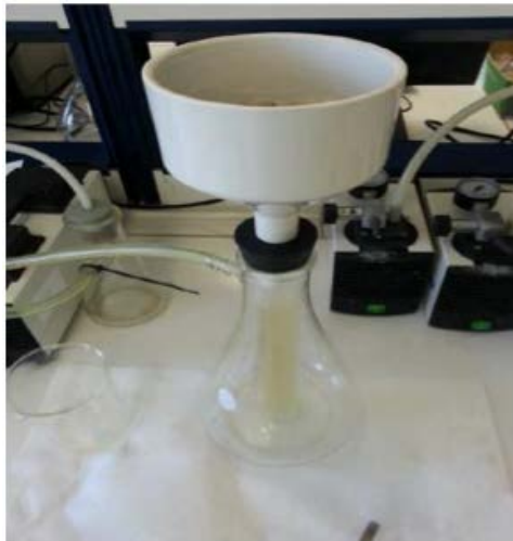
Σχήμα 37: Συσκευή διάταξης διήθησης υπό κενό
