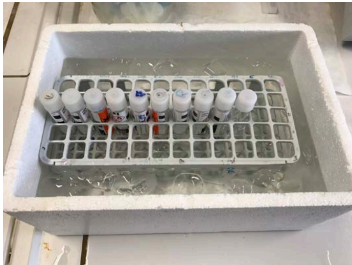
Σχήμα 42: Τα δείγματα στο παγόλουτρο κατά τον προσδιορισμό του αμύλου
