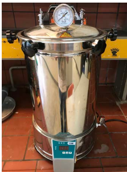
Σχήμα 41: Κλίβανος αποστείρωσης ISOLAB Laborgerate GmbH Autoclave
