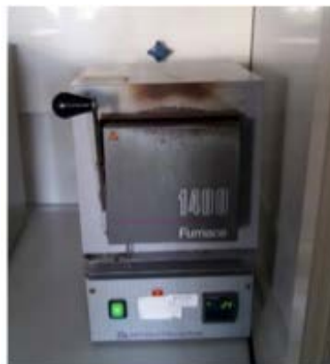
Σχήμα 26: Φούρνος μέτρησης πτητικών στερεών
