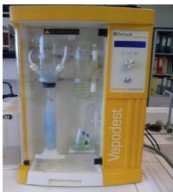
Σχήμα 33: Συσσκευή απόσταξης VapoDest
