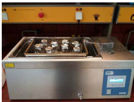
Σχήμα 20: Ανακινούμενο υδατόλουτρο Unitronic-Orbital
