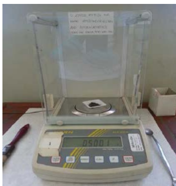
Σχήμα 23: Ζυγός ακριβείας 4 δεκαδικών ψηφίων
