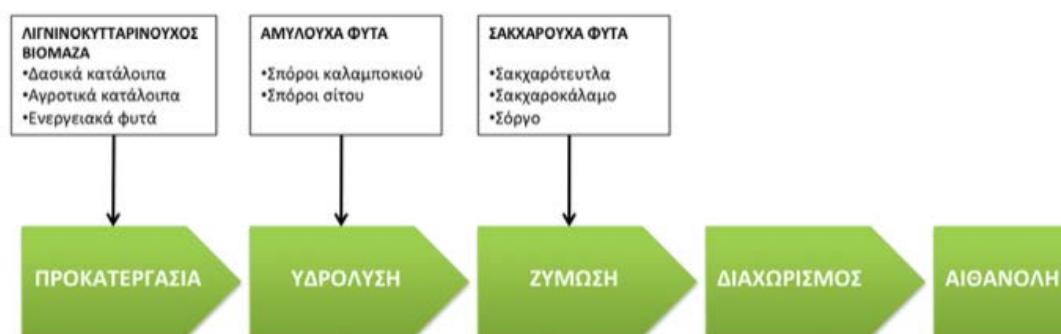
Σχήμα 9: Διεργασίες παραγωγής αιθανόλης από διάφορα υποστρώματα [33]
