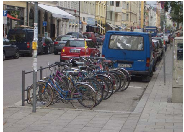
Εικόνα 6.15 – Υποδομή για στάθμευση ποδηλάτου με κατάλληλη υποδοχή για το μπροστινό ή πίσω τροχό, ώστε να «στέκεται» το ποδήλατο, Copenhagen Denmark Πηγή “ http://ecologicalurbanliving.blogspot.com ”
