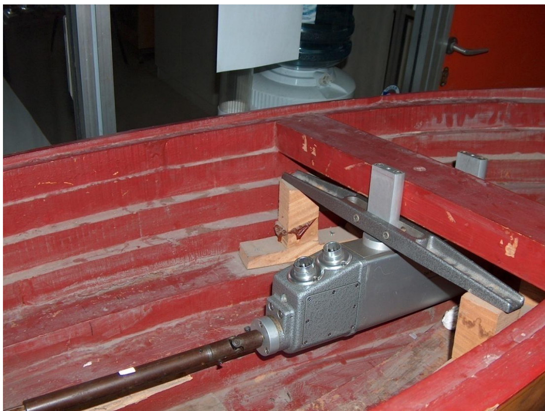
Εικόνα 5: Δυναμόμετρο Πειραμάτων Αυτοπρόωσης
