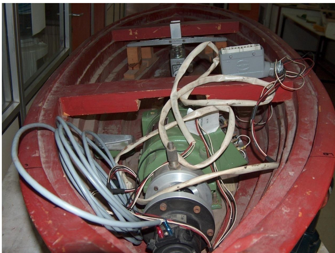
Εικόνα 4 : Εσωτερικό μοντέλου με τον εξοπλισμό της αυτοπρόωσης
