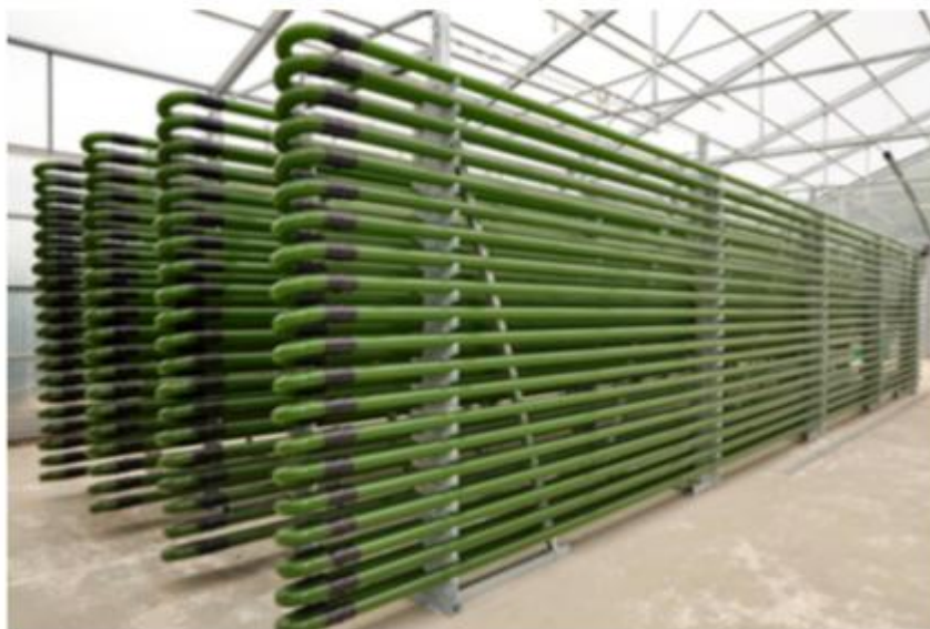
Σχήμα 3.3 : Αυλωτός φωτοβιοαντιδραστήρας για παραγωγή υψηλής αξίας προϊόντων από μικροφύκη (IGV-Biotech) [13]
