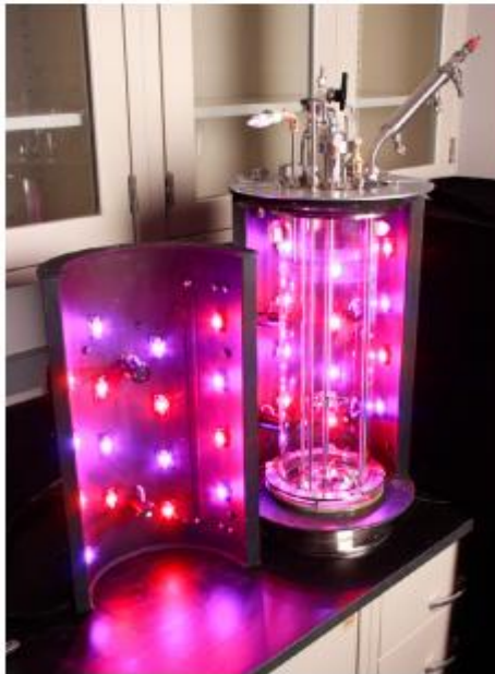
Σχήμα 4.4 : Φωτοβιοαντιδραστήρας με ενσωματωμένες λυχνίες LED για την παραγωγή βιομάζας μικροφυκών. [13]
