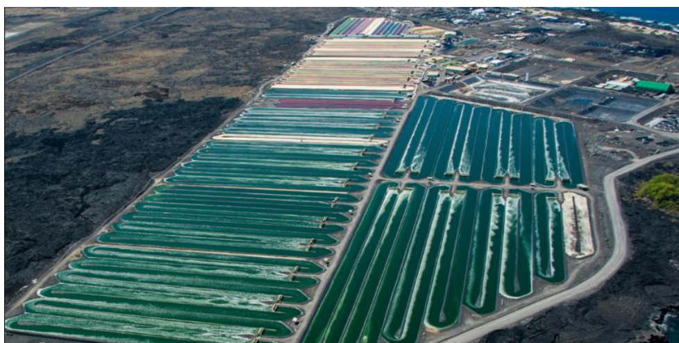
Σχήμα 3.2 : Ανοιχτό σύστημα καλλιέργειας με επιμήκεις λεκάνες στη Cynanotech, Χαβάη. [50]
