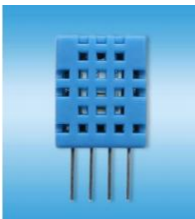
Σχήμα 5.2 : Αισθητήρας θερμοκρασίας και σχετικής υγρασίας DHT 11, της Aosong. [95]
