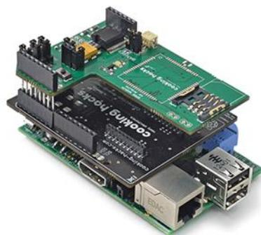
ΕΙΚΟΝΑ 27. ΣΥΝΔΕΣΗ GSM MODULE ΜΕ RASPBERRY PI
