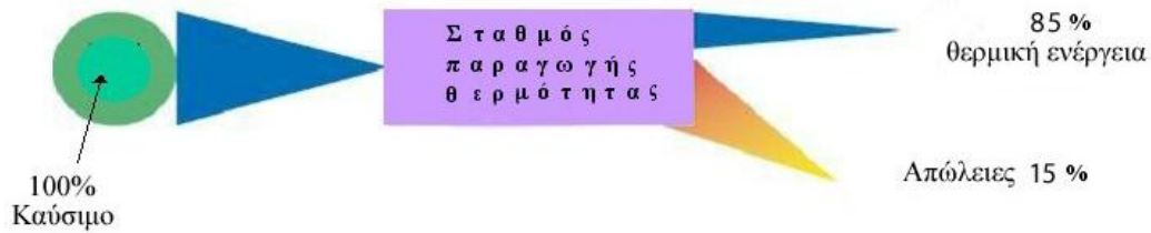
Σχήμα 1.1(β). Συμβατικό σύστημα παραγωγής θερμικής ενέργειας
