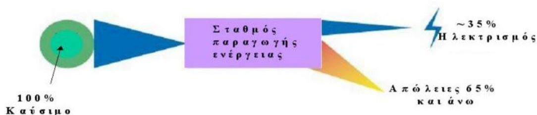
Σχήμα 1.1(α). Συμβατικό σύστημα παραγωγής ηλεκτρικής ενέργειας
