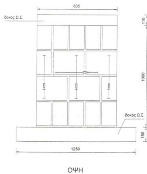
Σχ. 3.2: Δοκιμές θλίψεως τοίχων. Γεωμετρία δοκιμίων και θέσεις τοποθέτησης των μετρικών οργάνων (διαστάσεις σε mm)
