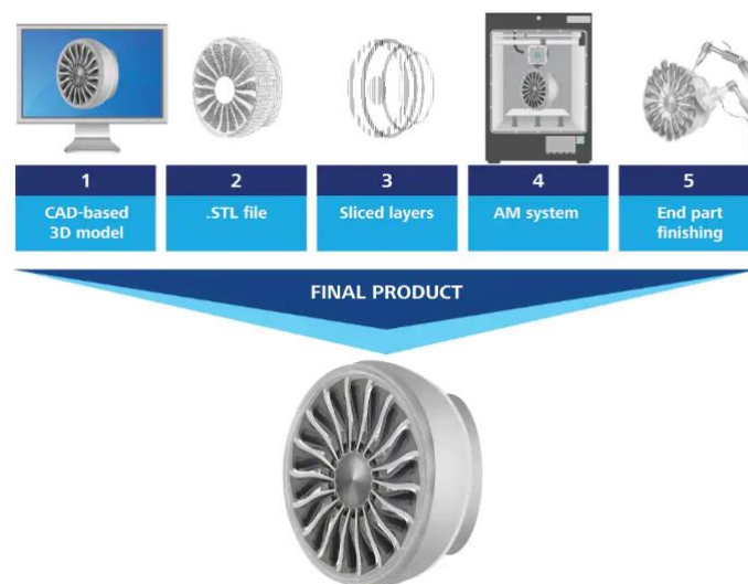
Σχήμα 1.1.1 Βήματα υλοποίησης τρισδιάστατης εκτύπωσης (Deloitte University Press)
