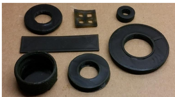
Σχήμα 2.2.1 Κατασκευασμένα αντικείμενα με τη δίοδο λέιζερ 100mW
