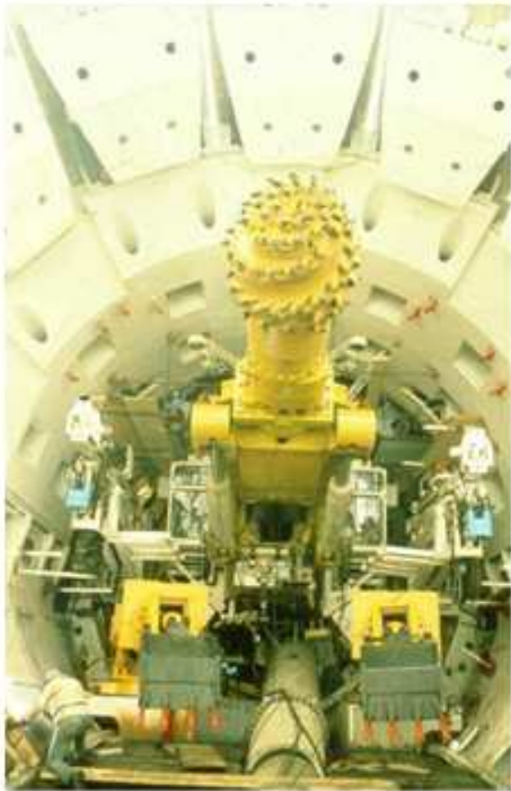
Εικόνα 1.11 - Μηχάνημα σημειακής κοπής (Open Face Shield – OFS) (Αττικό Μετρό, 2007)
