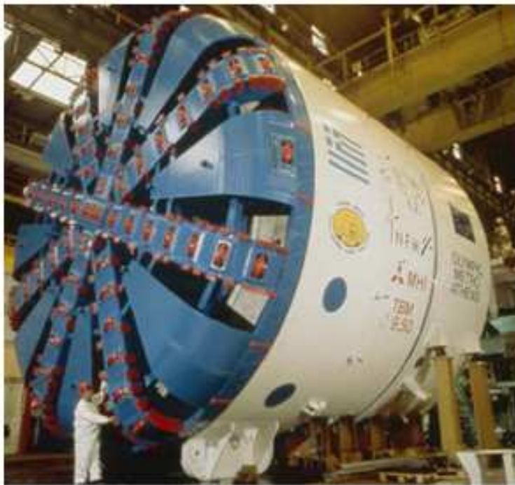
Εικόνα 1.10 - Μηχάνημα ολομέτωπης κοπή(TBM). (Αττικό Μετρό, 2007)
