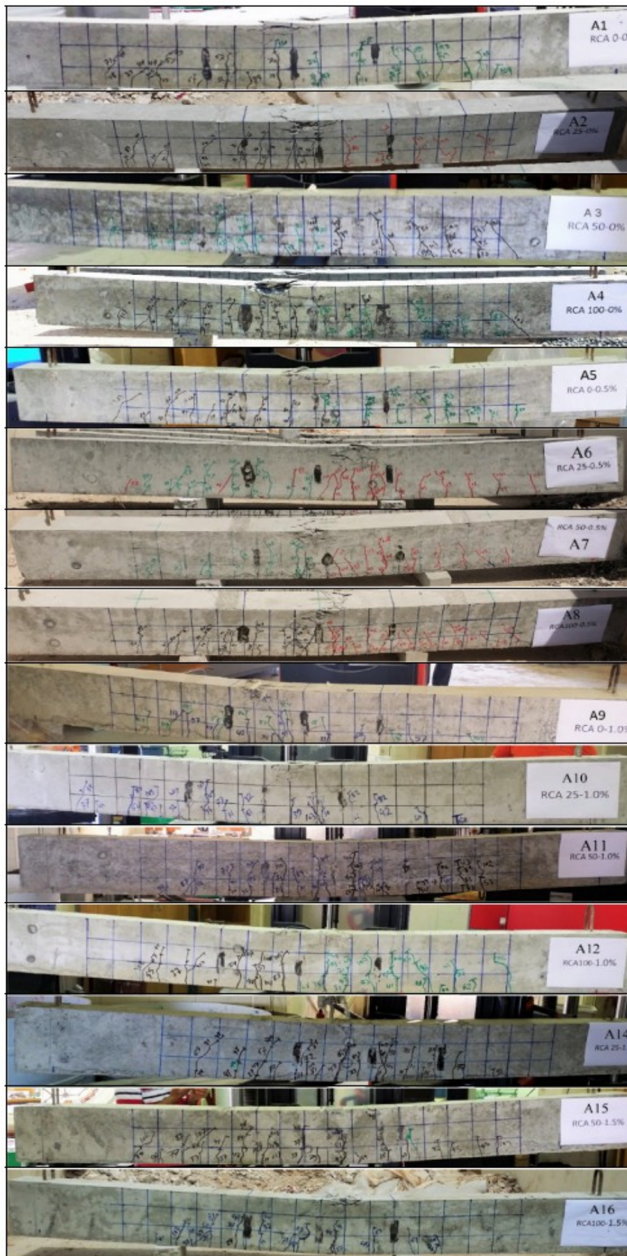
Εικόνα 4: Διάταξη ρηγματωμένων δοκιμίων
