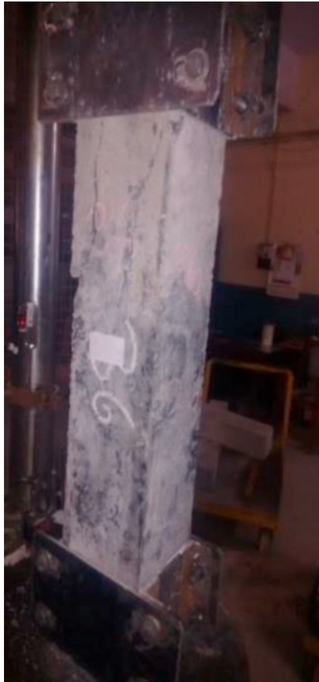
Εικόνα 2: Μορφή αστοχίας στύλου Τύπου I
