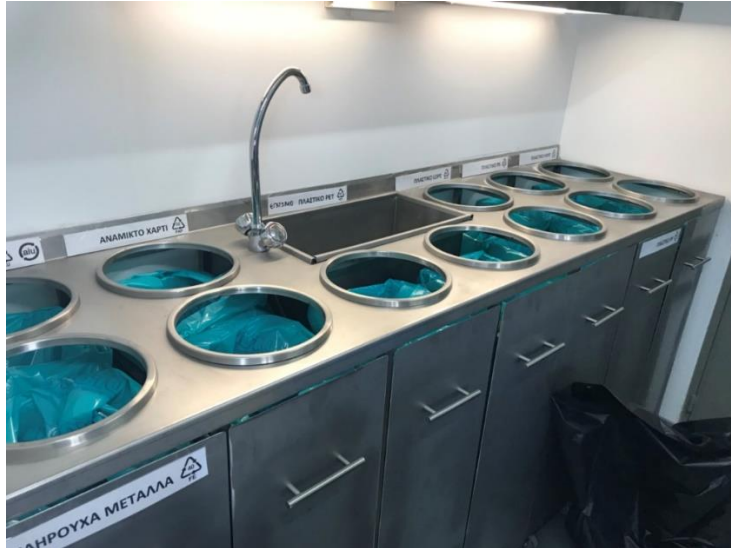
Εικόνα 27. Οργάνωση υποδοχέων (slots) για τον λεπτομερή διαχωρισμό των υλικών
