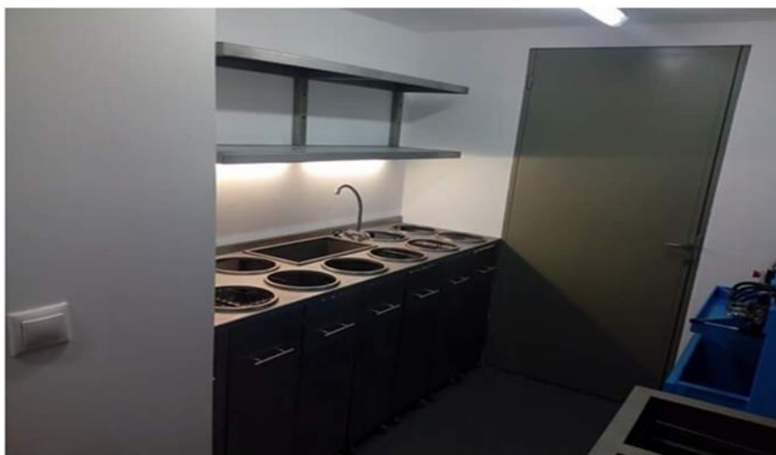
Εικόνα 9. Το σύστημα πλύσης και οι 12 θυρίδες διαλογής ( slots ) (Πηγή: PAVEtheWAYSTE ε , Παραδοτέο B2.3)
