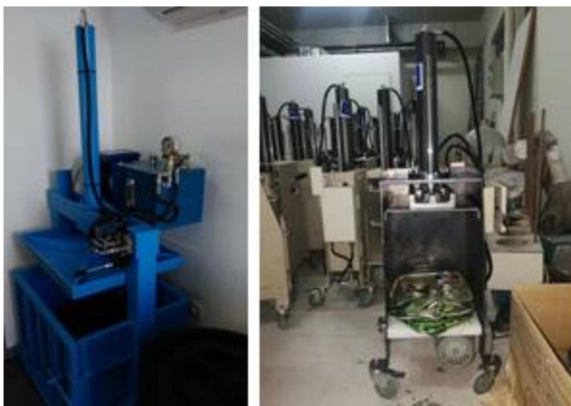
Εικόνα 7. Μεγάλη και μικρή πρέσα/δεματοποιητής στα αριστερά και δεξιά αντίστοιχα (Πηγή: PAVEtheWAYSTE ε , Παραδοτέο B2.3)
