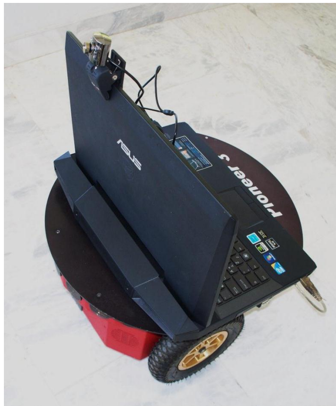
Σχημα 30. Η πειραματική διάταξη: ρομπωτικό όχημα Pioneer 3-DX, με τοποθετημένο φορητό υπολογιστή και USB κάμερα.
