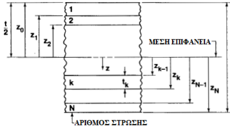
Σχήμα 1. 21: Γεωμετρία ενός πολύστρωτου N-στρώσεων
