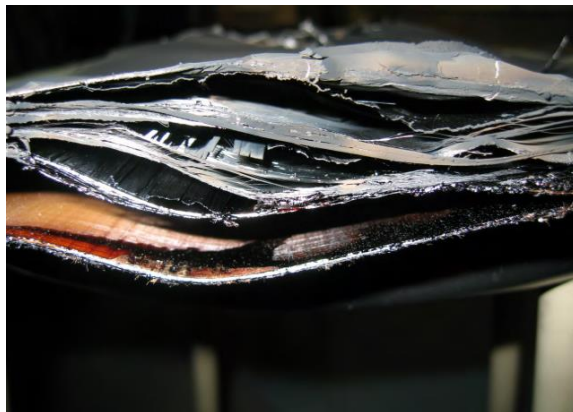
Σχήμα 1.16(γ): Λεπτομέρεια αποκόλλησης των στρώσεων GLARE μετά το τεστ.
