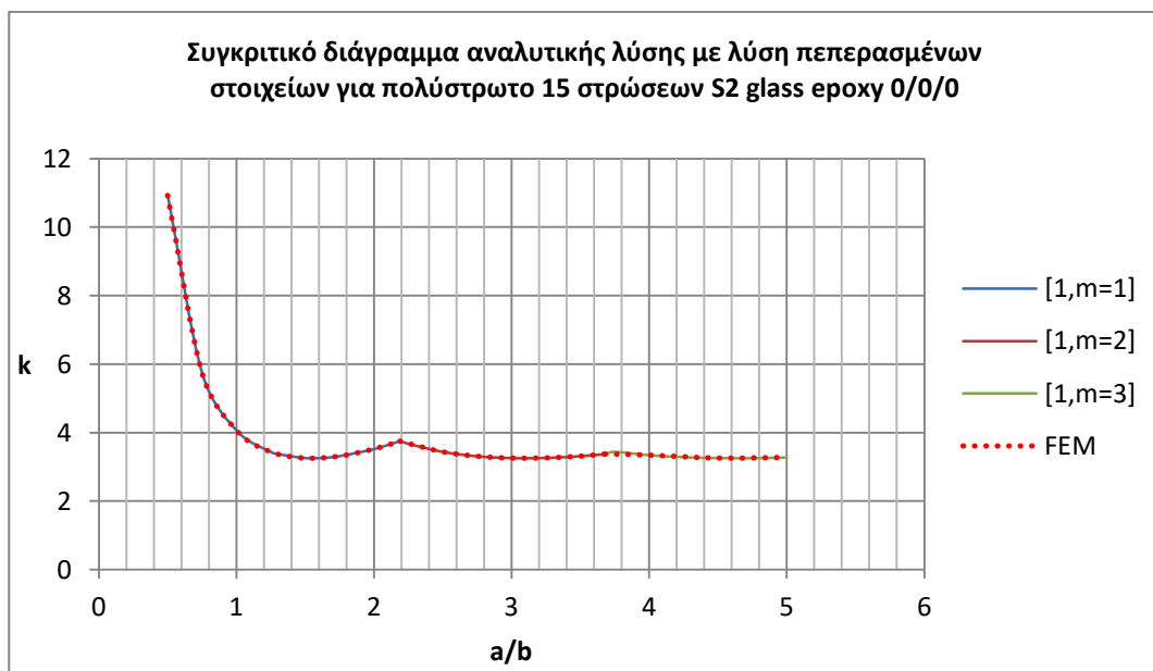
Σχήμα 3. 10: Συγκριτικό διάγραμμα αναλυτικής-αριθμητικής λύσης ( k - a/b ) πολύστρωτου προσανατολισμού 0/0/0 για θλίψη με απλή έδραση
