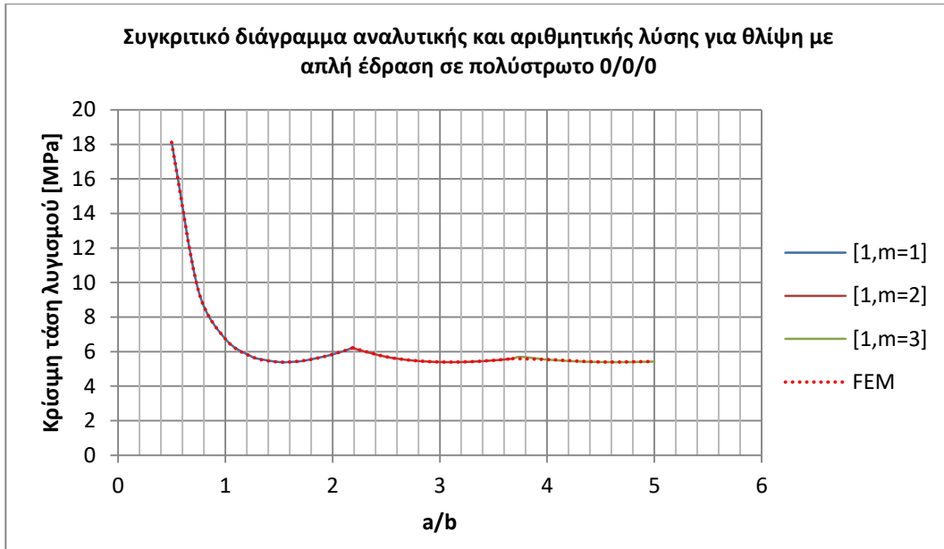
Σχήμα 3. 11: Συγκριτικό διάγραμμα κρίσιμης τάσης λυγισμού αναλυτικής-αριθμητικής λύσης πολύστρωτου S2-glass/epoxy προσανατολισμού 0/0/0 για θλίψη με απλή έδραση
