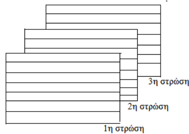
Σχήμα 3. 6: Σχηματική αναπαράσταση του προσανατολισμού των στρώσεων για πολύστρωτο σύνθετο S2 glass/epoxy 0/0/0/...
