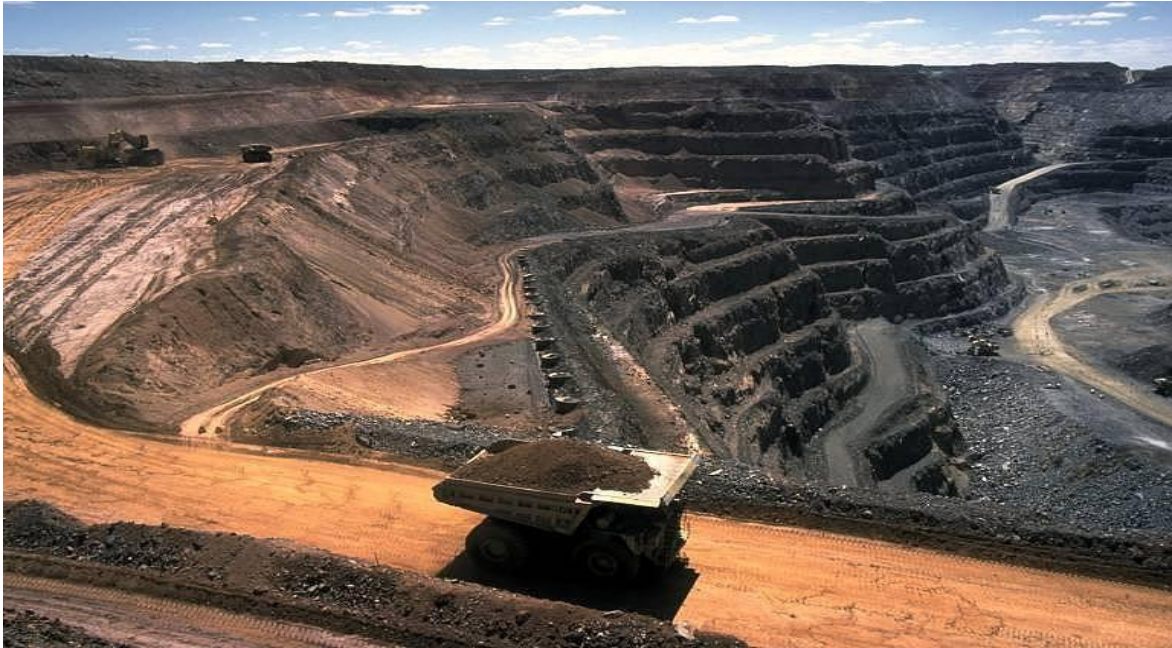
Εικόνα 1.3.1 Μέθοδος Εκμετάλλευσης Strip Mining
