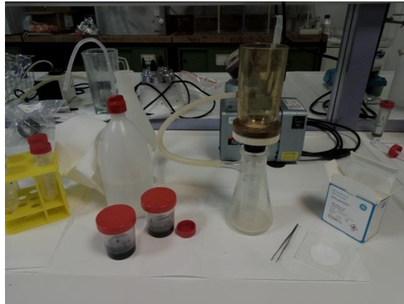
Εικόνα 3.9: Διήθηση δείγματος για μέτρηση διαλυτού COD
