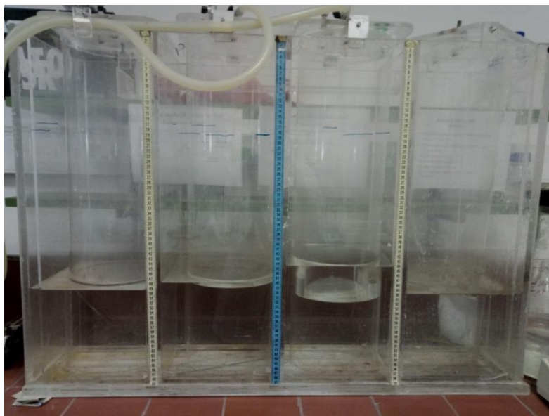
Εικόνα 3.3: Πειραματική διάταξη συστήματος συλλογής βιοαερίου
