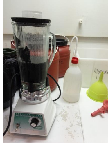
Εικόνα 3.4: Τροφοδοσία χωνευτών (μικτή ιλύς) όπως έφτανε στο εργαστήριο και ομογενοποίησή της
