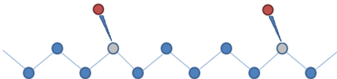
Σχήμα 29. Δομή του EPM με σφαίρες σε all-trans διαμόρφωση στο επίπεδο. Με μπλε σφαίρα αναπαρίσταται το ενοποιημένο άτομο \text{CH}_2 , με γκρι το \text{CH} και το με κόκκινο το \text{CH}_3 . Τα μονομερή των προπυλενίων κατανέμονται τυχαία κατά μήκος της αλυσίδας.
