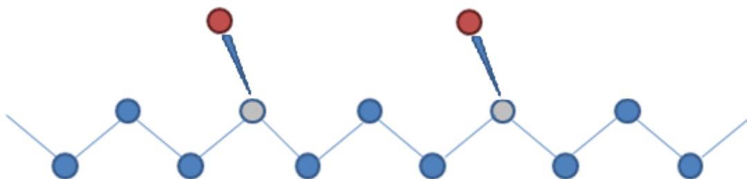
Σχήμα 30. Δομή του alt-PEP με σφαίρες σε all-trans διαμόρφωση στο επίπεδο. Με μπλε σφαίρα αναπαρίσταται το ενοποιημένο άτομο \text{CH}_2 , με γκρι το \text{CH} και το με κόκκινο το \text{CH}_3 . Τα μονομερή των αιθυλενίων και των προπυλενίων τοποθετούνται εναλλάξ μεταξύ τους.
