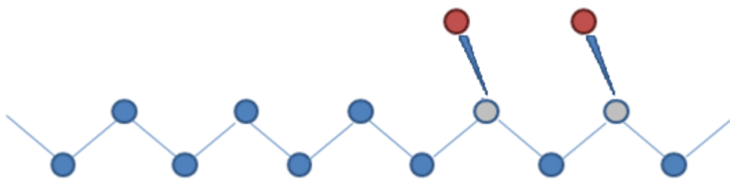
Σχήμα 28. Δομή του PE -b-PP με σφαίρες σε all-trans διαμόρφωση στο επίπεδο. Με μπλε σφαίρα αναπαρίστανται το ενοποιημένο άτομο CH_2 , με γκρι το CH και το με κόκκινο το CH_3 . Το πολυπροπυλένιο ακολουθεί το πολυαιθυλένιο.
