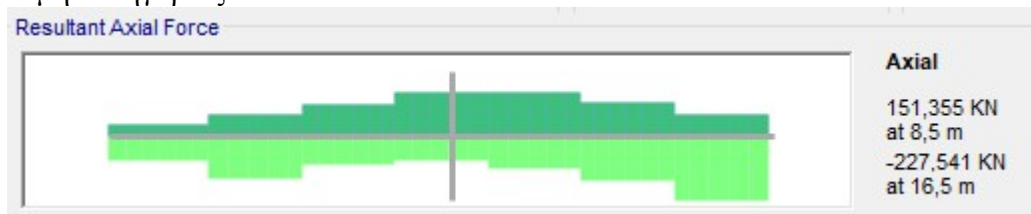
Εικόνα 7-5: Περιβάλλουσα αξονική δύναμη της δοκού κάτω πέλματος δικτυώματος της δικτυωτής πεζογέφυρας
