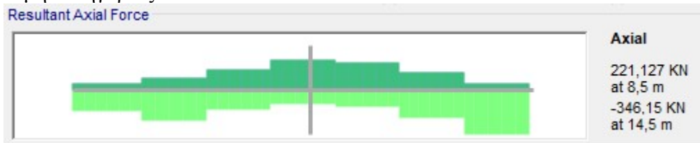
Εικόνα 7-19: Περιβάλλουσα αξονική δύναμη της δοκού κάτω πέλματος δικτυώματος της δικτυωτής πεζογέφυρας
