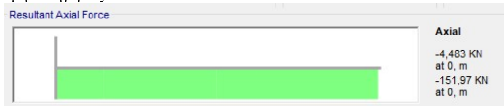
Εικόνα 7-8: Περιβάλλουσα αξονική δύναμη της κατακόρυφης δοκού δικτυώματος (IPE140) της δικτυωτής πεζογέφυρας
