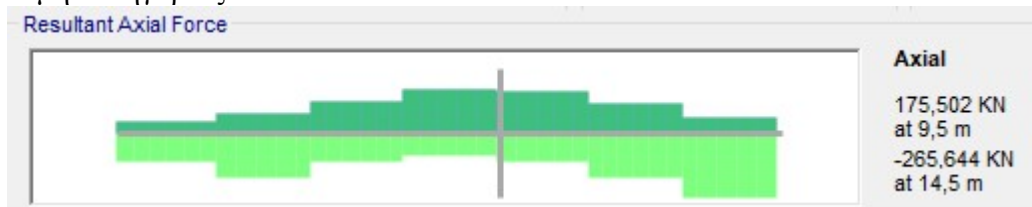
Εικόνα 7-13: Περιβάλλουσα αξονική δύναμη της δοκού κάτω πέλματος δικτυώματος της δικτυωτής πεζογέφυρας
