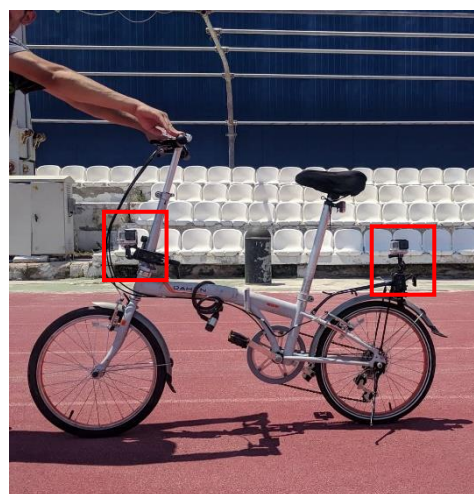
Εικόνα 17: Θέση τοποθέτησης των δύο καμερών GoPro στο ποδήλατο
