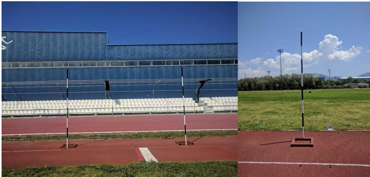
Εικόνα 19: Οι σιδερένιοι στύλοι διαβάθμισης για τη δισδιάστατη απόδοση κλίμακας. Αριστερά, η τοποθέτησή τους κατά τη διάρκεια των αλμάτων και δεξιά, η μετακίνησή τους στο κέντρο του διαδρόμου μετά το πέρας των αλμάτων για να γίνει η καταγραφή τους.
