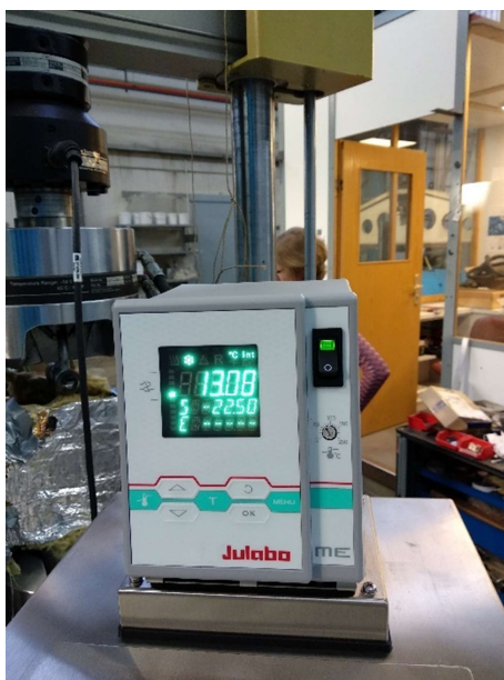
Εικόνα 3.3: Ενδείξεις θερμοστάτη: Πάνω: θερμοκρασία εντός του δοχείου, Κάτω: επιθυμητή θερμοκρασία του δοκιμίου
