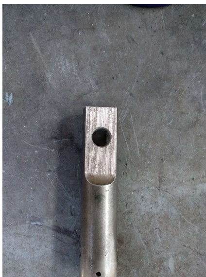
Εικόνα 3.14: Οπή για την εισαγωγή του θερμομέτρου Figure 3.14: Opening for the insertion of the thermometer
