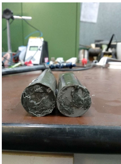
Εικόνα 3.32: Δοκίμιο ύστερα από τη θραύση του Figure 3.32: Specimen after crashing
