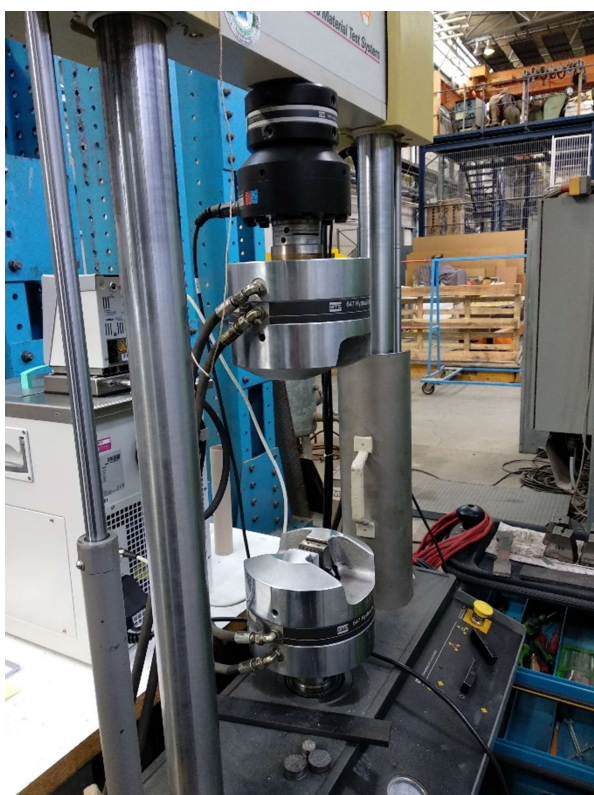
Εικόνα 3.8: Συσκευή εφελκυσμού MTS 810 Figure 3.8: MTS 810 Tension Apparatus
