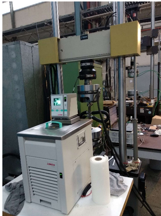
Εικόνα 3.29: Πλήρης πειραματική διάταξη με θερμοστάτη Figure 3.29: Complete experimental device with thermostat
