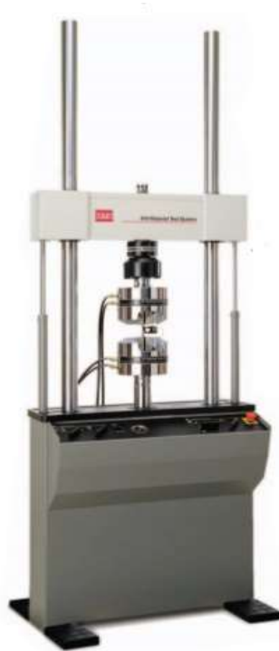
Εικόνα 3.9: Συσκευή εφελκυσμού MTS 810 Figure 3.9: MTS 810 Tension Apparatus
