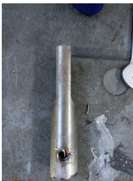
Εικόνα 3.13: Οπή για την εισαγωγή του σωλήνα θερμαντικού λαδιού Figure 3.13: Opening for the insertion of heat oil pipe
