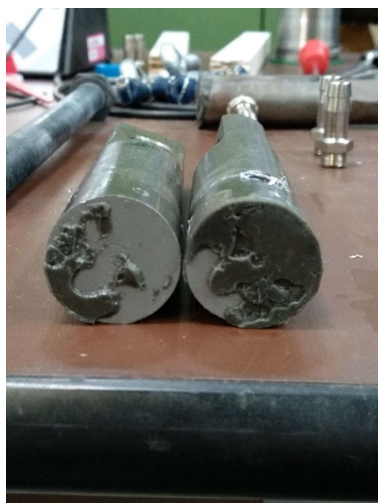
Εικόνα 3.33: Δοκίμιο πειράματος σε θερμοκρασία 23οC και ταχύτητα 1mm/min Figure 3.33: Experimental specimen at 23°C and 1mm / min
