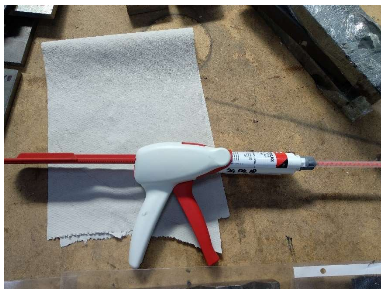
Εικόνα 3.20: Πιστόλι και αναμεικτήρες Figure 3.20: Final welding pistol configuration
