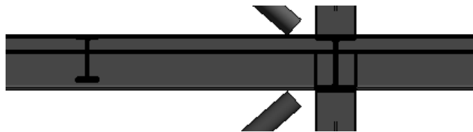
Σχήμα 7.8: Εκκεντρότητα δοκών ως προς τον κεντροβαρικό άξονα της πλάκας
