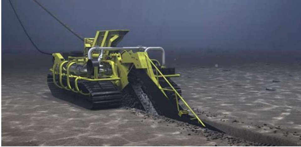
Εικόνα 4-6: Εγκατάσταση καλωδίων μέσης τάσης με χρήση ROV [24]
