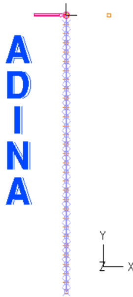
Εικόνα 3-17: Μοντέλο πασσάλου-εδάφους στο ADINA
