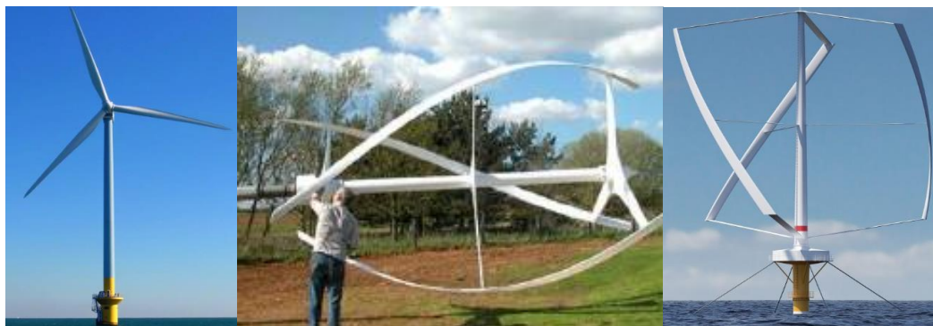
Εικόνα 1-6: Τύποι ανεμογεννητριών α)οριζόντιου άξονα με περιστροφή παράλληλη στον άνεμο [10], β)οριζόντιου άξονα με περιστροφή κάθετη στον άνεμο [11], γ)κατακόρυφου άξονα [12]
