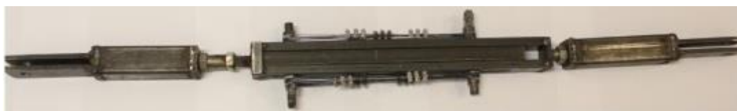
(α) Απεικόνιση του «ενισχυμένου» από κράματα μνήμης σχήματος χιαστί συνδέσμου
