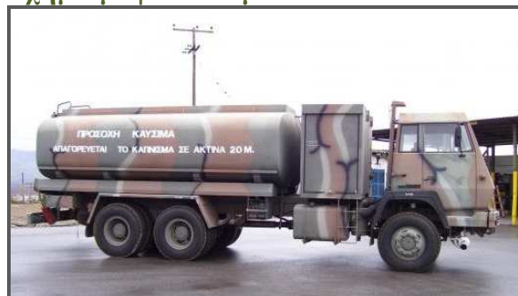
Εικόνα 4.13 Βυτιοφόρο όχημα STEYR Μεταφοράς καυσίμων
