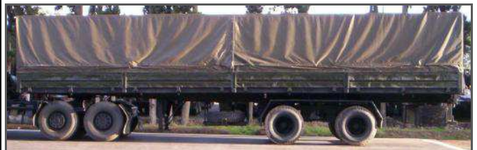
Εικόνα 4.28 Ρυμουλκούμενη πλατφόρμα 30 τον
