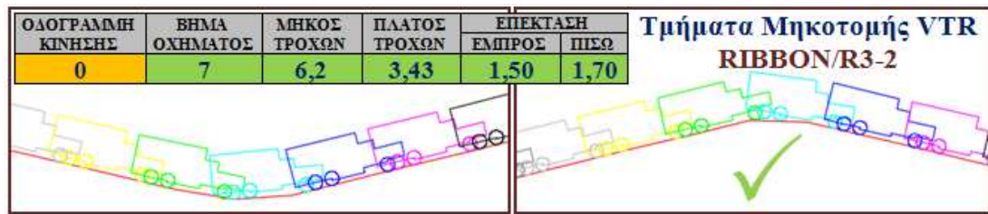
Εικόνα 6.24ii Απεικόνιση κίνησης οχήματος μτφ RIBBON στην οδό R3 (R3-1, R3-2), μέσω VTR
