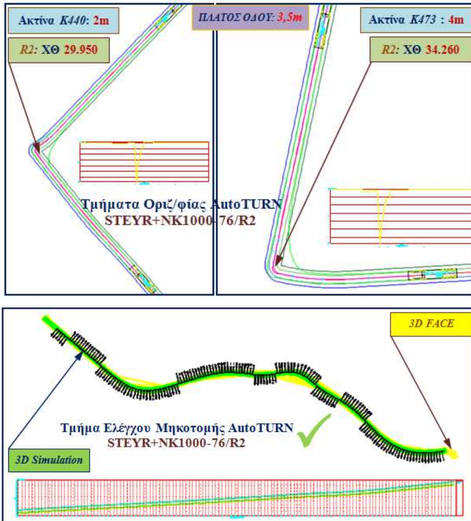
Εικόνα 6.55 Απεικόνιση κίνησης STEYR M60 με NK1000-76 στην οδό R2, μέσω AutoTURN
