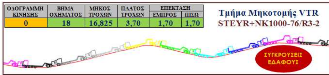
Εικόνα 6.32ii Απεικόνιση κίνησης οχήματος STEYR M60 με NK1000-76 στην οδό R3a, μέσω VTR
