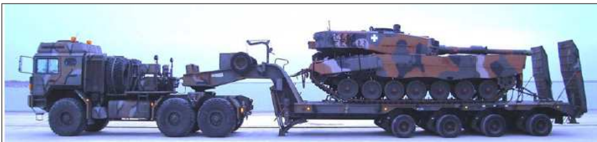
Εικόνα 4.7 Ρυμουκλό όχημα STEYER 40 M60/S40 με αρματοφορέα NK 1000-76 κατά τη μεταφορά άρματος μάχης LEOPARD 2 A6 HEL
