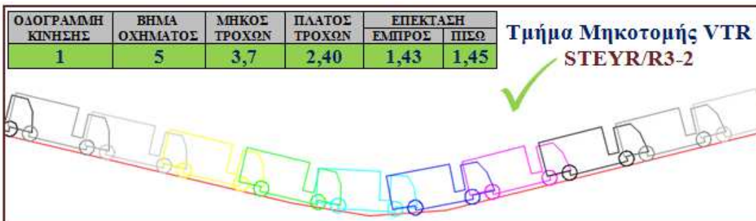
Εικόνα 6.16ii Απεικόνιση κίνησης οχήματος STEYR στην οδό R3 (R3-1, R3-2), μέσω VTR
