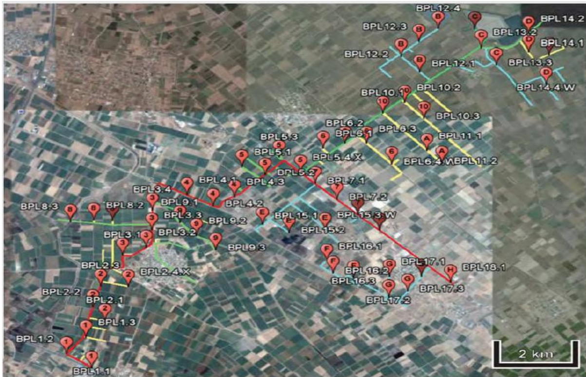
Εικόνα 1.12: Το υβριδικό ασύρματο- BPL δίκτυο που αναπτύχθηκε στη Λάρισα (Ελλάδα) από τη ΔΕΗ, BPL μονάδες στην δεύτερη γραμμή MT
