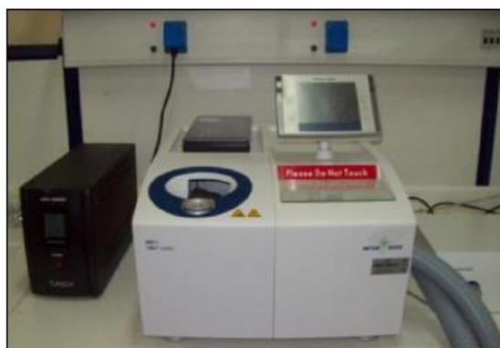
Σχήμα 2.22 : Συσκευή Mettler DSC 1 STAR System [81]
