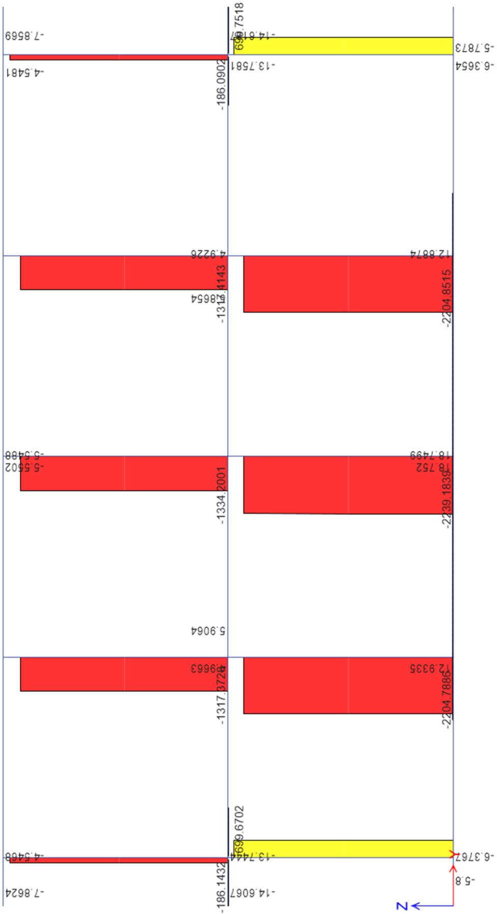
Σχήμα 5.3: Αξονικές δυνάμεις Τομής C-C - DSt1S16(T) (G + Q + W + S)
